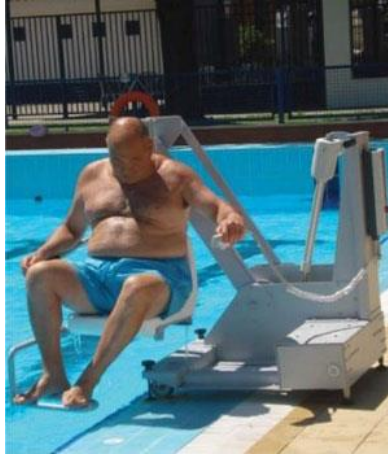
Figura 15. Grúa fijación mediante pesas.
