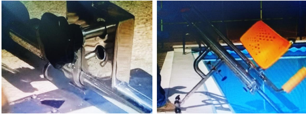
Figura 16. Grúa empotrada con un gancho [17].
