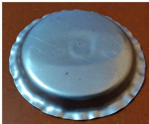
Vista exterior de la pieza obtenida en el ensayo de embutición #3
