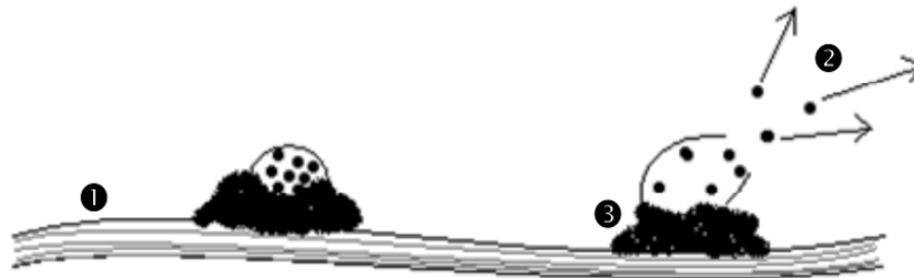
Figura 12. Representación esquemática de la liberación del agente activo sobre la piel: 1) sustrato textil, 2) resina y 3) liberación del agente activo
