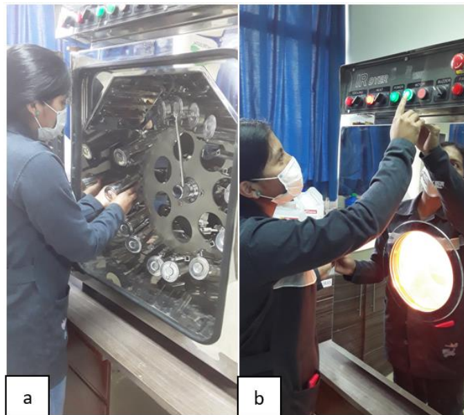
Anexo N° 6. Alimentación al Autoclave: a) Alimentación de los vasos en la máquina y b) Programación de la curva.
