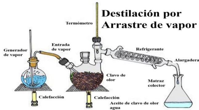
Figura 9. Método de destilación por arrastre de vapor
