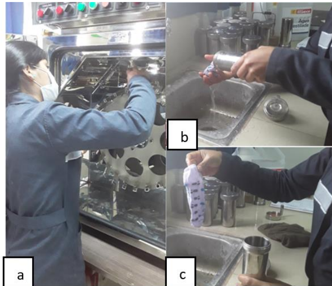
Anexo N° 7. Descarga de material: a) Descarga de vasos de la máquina, b) Botar el baño y c) Retiro de material del baño
