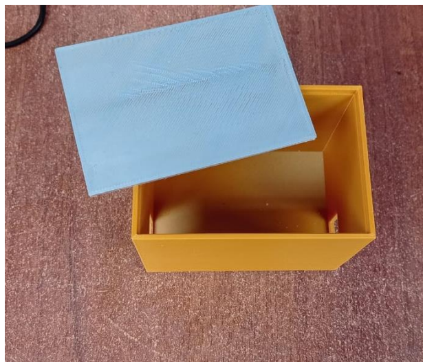
Figura 4.22 Impresión 3D de la caja de protección de los circuitos
