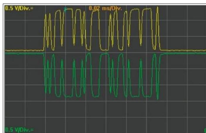
**Figura 1.21** Oscilograma de las señales del BUS de datos, se puede observar la señal CAN High en amarillo y la señal CAN Low en verde.
