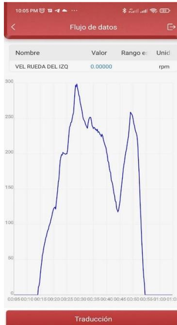
**Figura 2.21** Señal del flujo de datos del escáner del WHEEL SPEED
