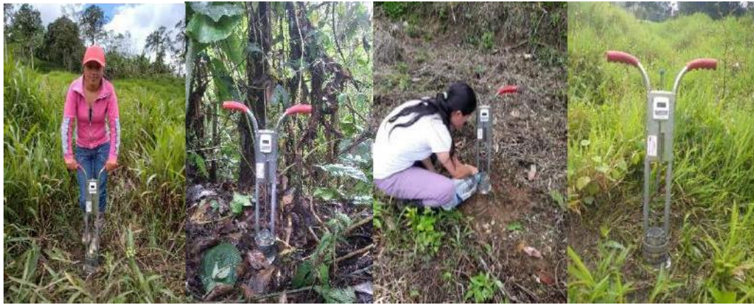
Figura 6. Medición de infiltración del agua en el suelo
