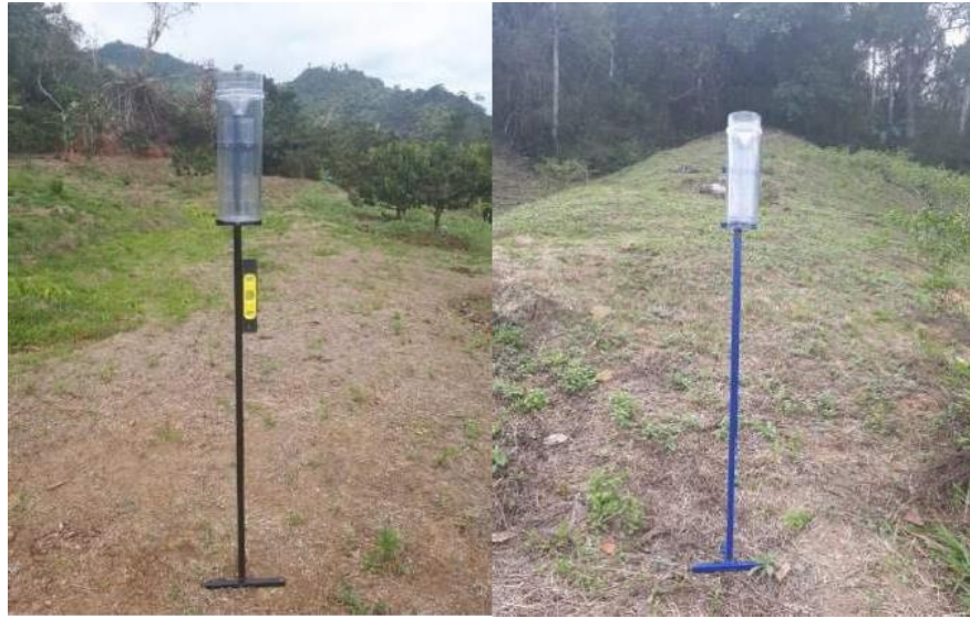
Figura 8. Instalación de pluviómetros
