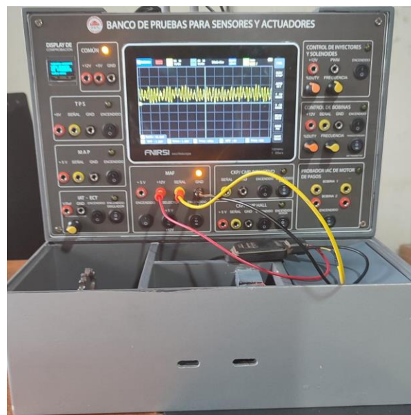
Figura 3.13 Oscilograma de sensor MAF con simulación física
