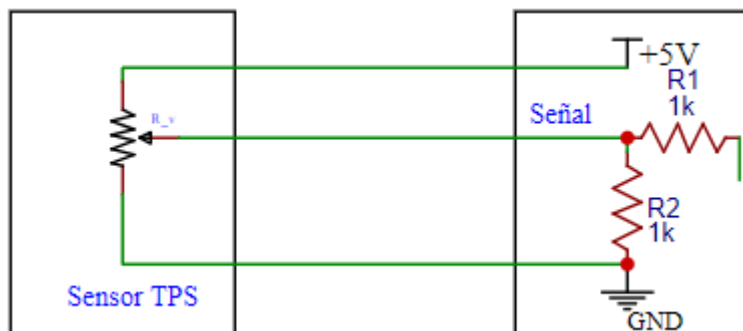
Figura 2.3 Circuito de funcionamiento sensor TPS
