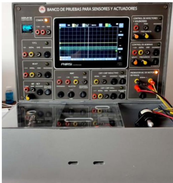
Figura 3.22 Simulación física de válvula IAC y conexión física
