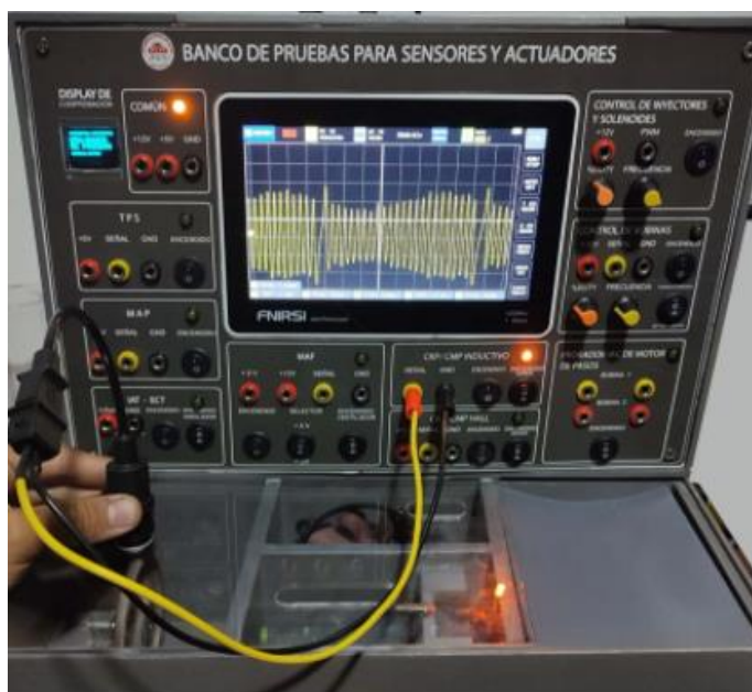
Figura 3.15 Oscilograma CKP inductivo y conexión física
