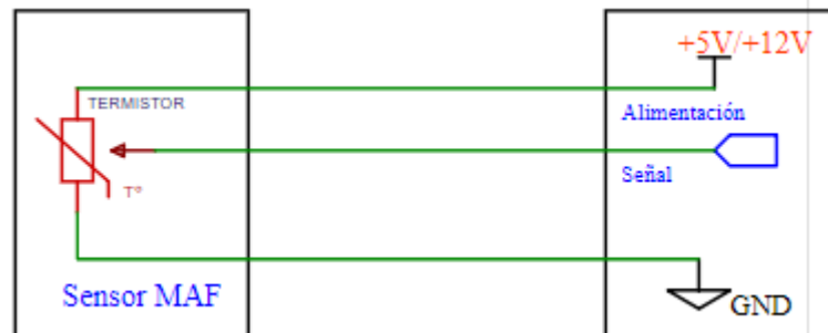
Figura 2.5 Circuito de funcionamiento sensor MAP
