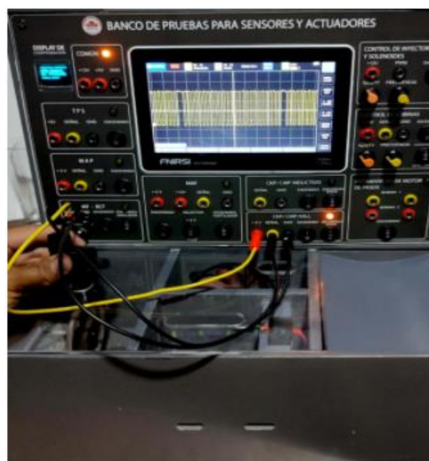
Figura 3.17 Oscilograma de sensor CMP Hall y conexión física
