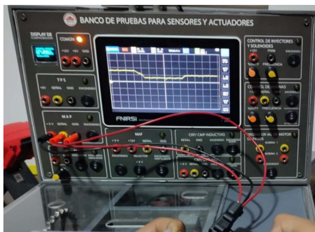
Figura 3.10 Oscilograma de funcionamiento de sensor MAP
