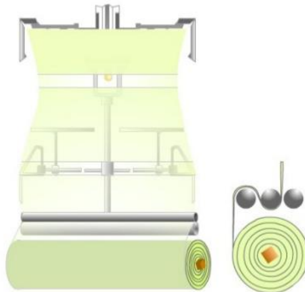
Figura 66. Tensado y arrollado por accionamiento mecánico.
