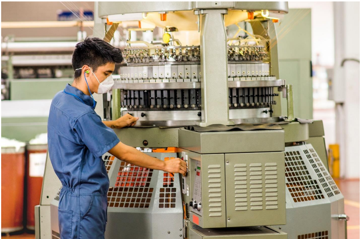
Figura 3. Mantenimiento de máquina circular
