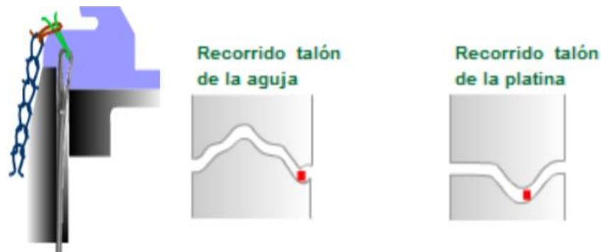
Figura 81. Posición de desprendimiento.
