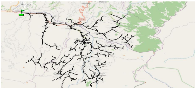
Figura 34 Circuito Alimentador X2 Subestación El Chota.
