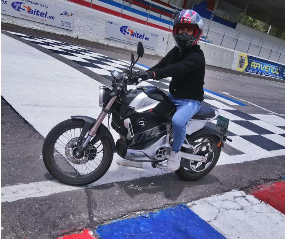
Figura AI 1 Iniciando prueba de coast-down
