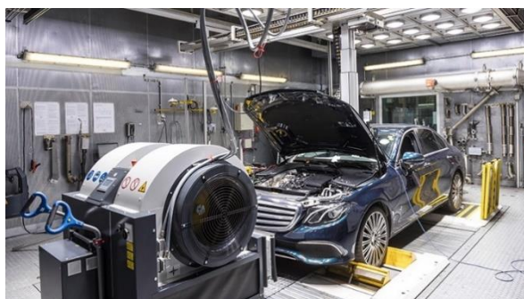
Figura 2.3 Vehículo sometido a un ciclo de conducción de laboratorio
