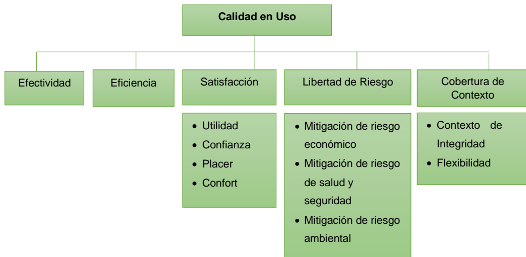
Figura 60. Características y sub características del modelo de calidad en uso. Fuente: ISO/IEC 25010
