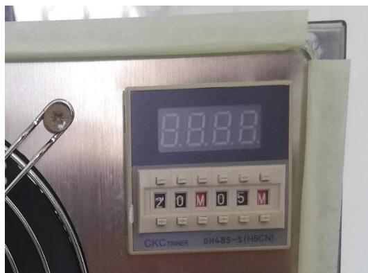
Figura 20. Programación de la máquina para que no sufra ningún daño, determinando si se trata de minutos u horas de trabajo y descanso.
