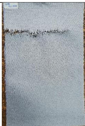
Figura 40. Probeta de urdimbre sometida a 50 min de ozonización, estado seco.
