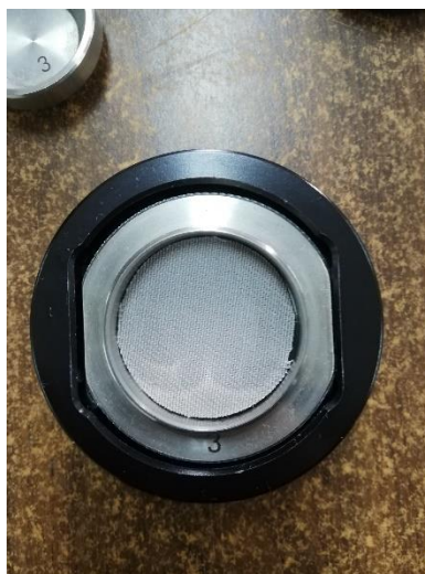
Figura 78. Incorporación de la tela ozonizada en el armazón.
