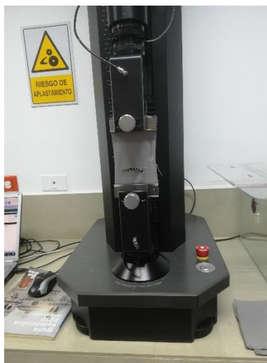
Figura 27. Confirmación de la máquina para el inicio del proceso de prueba de resistencia a la tracción-elongación.
