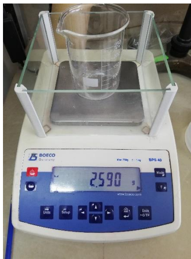
Figura 46. Pesaje del agua destilada necesaria para humectar a las probetas.
