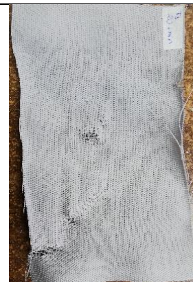
Figura 55. Probeta de trama sometida a 20 min de ozonización en estado húmedo, gabardina 1.
