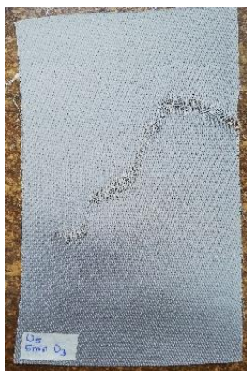
Figura 30. Probeta de urdimbre sometida a 5 min de ozonización, estado seco.
