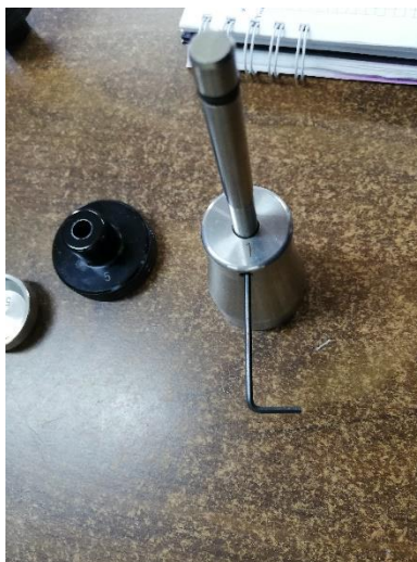
Figura 82. Fijación con la ayuda de la llave para colocar la pesa.
