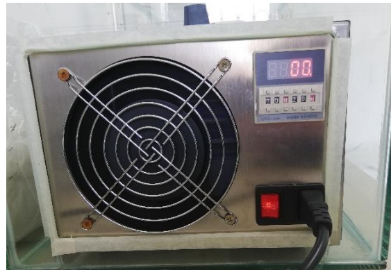
Figura 21. Funcionamiento de la máquina ozonizadora. Una vez que se encuentre hermetizada y programada se pulsa el botón de encendido para continuar con el tiempo de ozonización.
