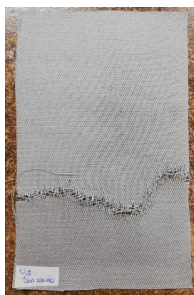
Figura 28. Probeta de urdimbre sometida a 0 min de ozonización, estado seco.
