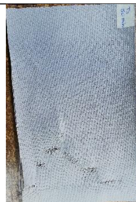
Figura 41. Probeta de trama sometida a 50 min de ozonización, estado seco.
