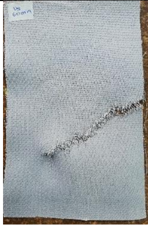
Figura 42. Probeta de urdimbre sometida a 65 min de ozonización, estado seco.
