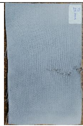
Figura 37. Probeta de trama sometida a 25 min de ozonización, estado seco.
