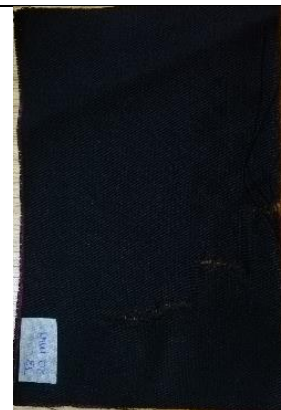
Figura 63. Probeta de trama sometida a 20 min de ozonización en estado húmedo, gabardina 2.
