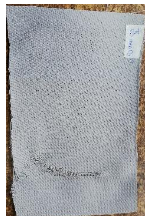
Figura 35. Probeta de trama sometida a 20 min de ozonización, estado seco.
