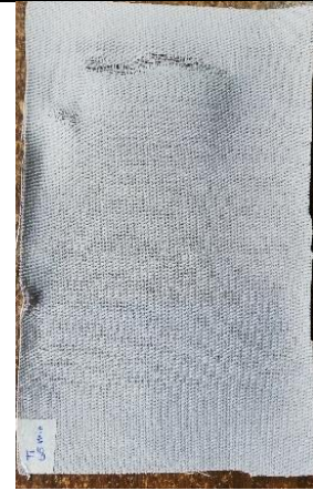
Figura 43. Probeta de trama sometida a 65 min de ozonización, estado seco.
