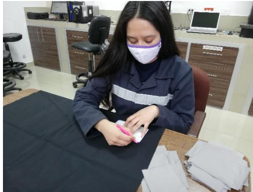
Figura 44. Con la ayuda del molde especificado por la norma ISO 13934-2 se realiza el corte de 10 cm x 15 cm en dirección de la urdimbre y trama.
