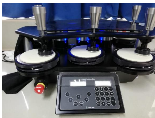
Figura 83. Programación de la máquina y el comienzo de los ciclos.
