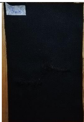
Figura 58. Probeta de urdimbre sometida a 0 min de ozonización en estado húmedo, gabardina 2.
