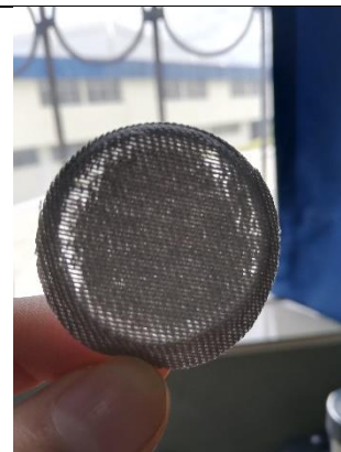
Figura 91. Muestra sometida a 35 min de ozonización, prueba de resistencia a la abrasión contraluz.
