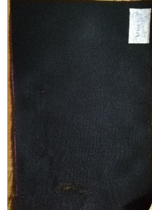
Figura 65. Probeta de trama sometida a 65 min de ozonización en estado húmedo, gabardina 2.
