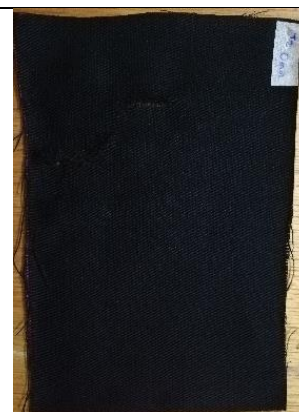
Figura 59. Probeta de trama sometida a 0 min de ozonización en estado húmedo, gabardina 2.
