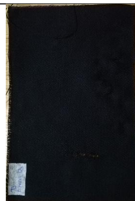
Figura 61. Probeta de trama sometida a 5 min de ozonización en estado húmedo, gabardina 2.
