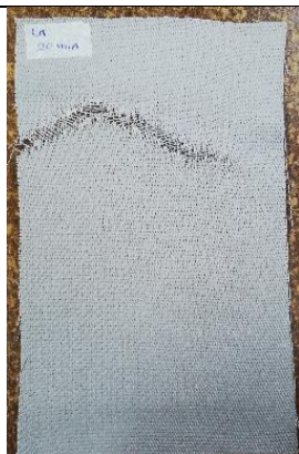
Figura 54. Probeta de urdimbre sometida a 20 min de ozonización en estado húmedo, gabardina 1.
