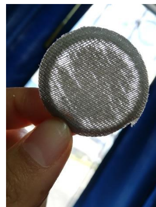
Figura 89. Muestra sometida a 15 min de ozonización, prueba de resistencia a la abrasión contraluz.
