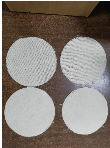
Figura 68. Verificación de la tela testigo cortada con los troqueles.
