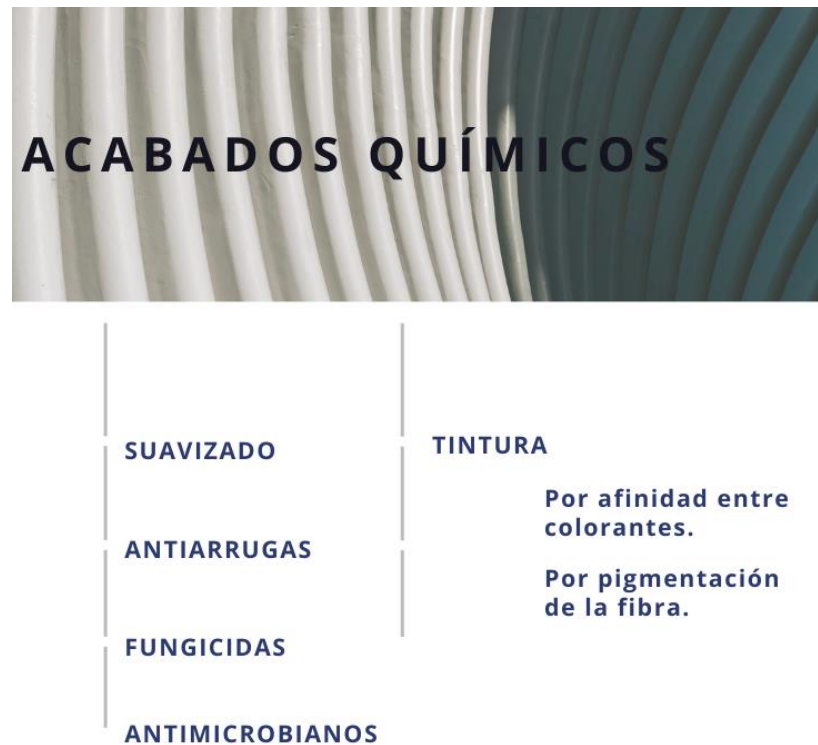
Figura 6. Tipos de acabados químicos.
