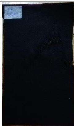
Figura 62. Probeta de urdimbre sometida a 20 min de ozonización en estado húmedo, gabardina 2.
