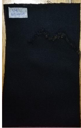
Figura 64. Probeta de urdimbre sometida a 65 min de ozonización en estado húmedo, gabardina 2.
