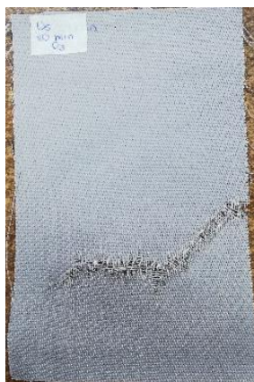
Figura 34. Probeta de urdimbre sometida a 20 min de ozonización, estado seco.
