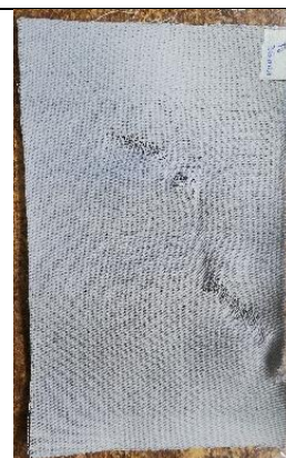
Figura 39. Probeta de trama sometida a 35 min de ozonización, estado seco.
