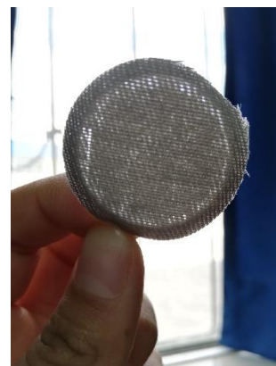
Figura 87. Muestra sometida a 5 min de ozonización, prueba de resistencia a la abrasión contraluz.
