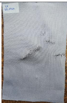
Figura 56. Probeta de urdimbre sometida a 65 min de ozonización en estado húmedo, gabardina 1.
