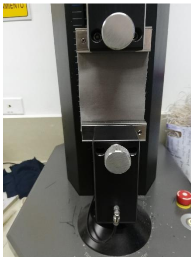
Figura 49. Inicio de las pruebas, en el equipo Dinamómetro.
