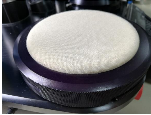
Figura 73. Incorporación del seguro en cada uno de los tambores para la fijación de la tela testigo.
