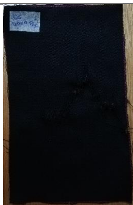
Figura 60. Probeta de urdimbre sometida a 5 min de ozonización en estado húmedo, gabardina 2.
