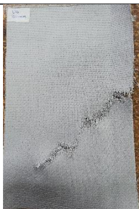
Figura 38. Probeta de urdimbre sometida a 35 min de ozonización, estado seco.
