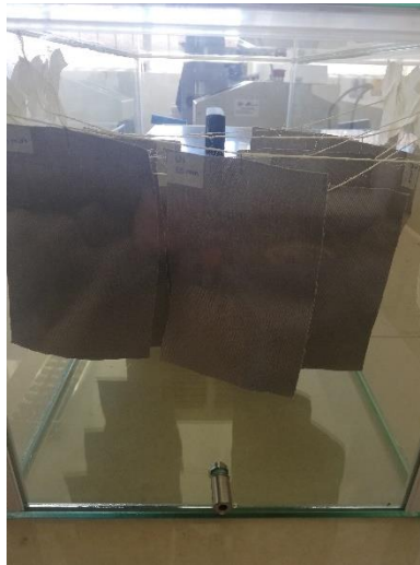
Figura 48. Ozonización a cada una de las probetas, con el mismo procedimiento 3.3.3.
