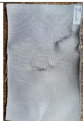
Figura 57. Probeta de trama sometida a 65 min de ozonización en estado húmedo, gabardina 1.
