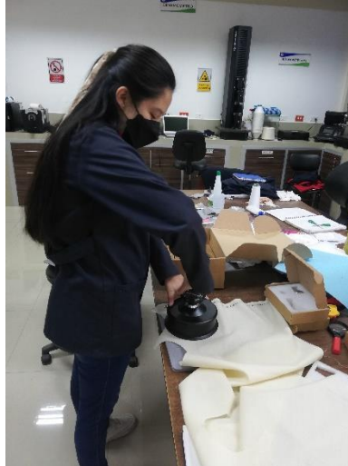
Figura 67. Tela testigo, debe ser troquelada como la norma lo especifica.
