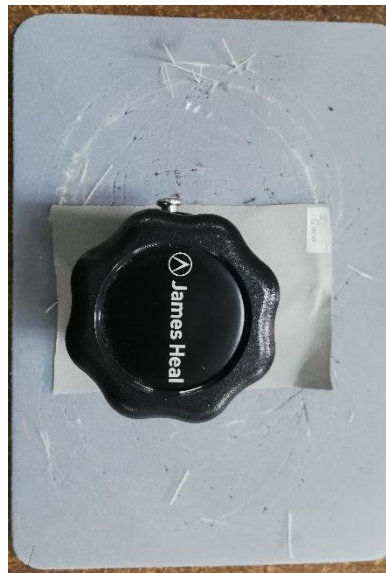
Figura 75. El troquelado de la tela ozonizada se lo realiza como lo especifica la norma.
