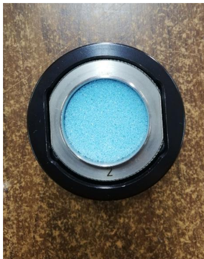
Figura 79. La esponja troquelada debe ser colocada sobre la tela ozonizada para que exista el realce necesario de esta.
