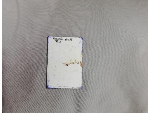
Figura 22. El corte en la tela se realiza con la ayuda del molde especificado por la norma ISO 13934-2 de 10 cm x 15 cm en dirección de la urdimbre y la trama.
