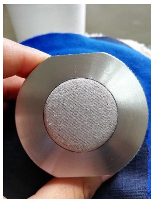
Figura 86. Muestra sometida a 5 min de ozonización, prueba de resistencia a la abrasión en el armazón.
