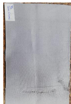
Figura 29. Probeta de trama sometida a 0 min de ozonización, estado seco.
