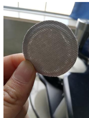
Figura 85. Muestra sometida a 0 min de ozonización, prueba de resistencia a la abrasión contraluz.
