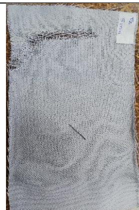
Figura 53. Probeta de trama sometida a 5 min de ozonización en estado húmedo, gabardina 1.
