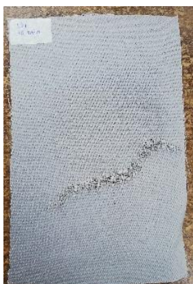
Figura 32. Probeta de urdimbre sometida a 15 min de ozonización, estado seco.
