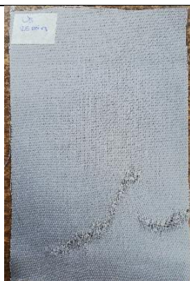
Figura 36. Probeta de urdimbre sometida a 25 min de ozonización, estado seco.
