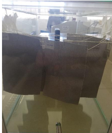
Figura 19. Hermetismo de la cámara se completa una vez cerrada la puerta lateral por la que entraron las probetas.
