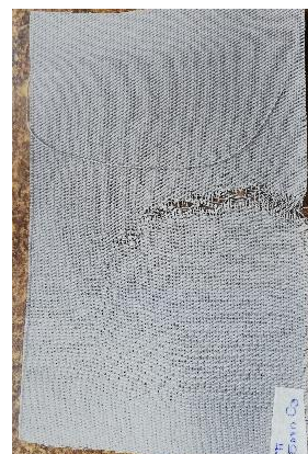
Figura 31. Probeta de trama sometida a 5 min de ozonización, estado seco.
