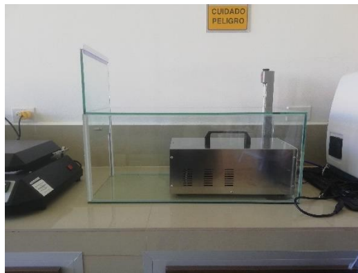
Figura 16. Apertura de la puerta lateral de la cámara ozonizadora
