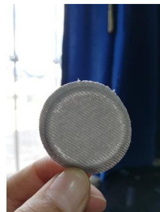
Figura 93. Muestra sometida a 65 min de ozonización, prueba de resistencia a la abrasión contraluz.
