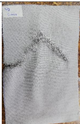
Figura 52. Probeta de urdimbre sometida a 5 min de ozonización en estado húmedo, gabardina 1.
