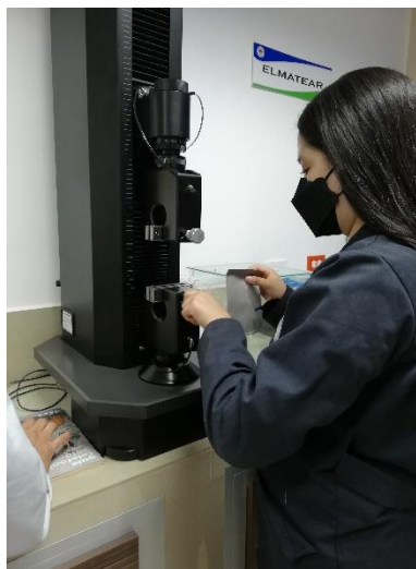
Figura 26. Ajuste manual de las mordazas para el inicio de la prueba.
