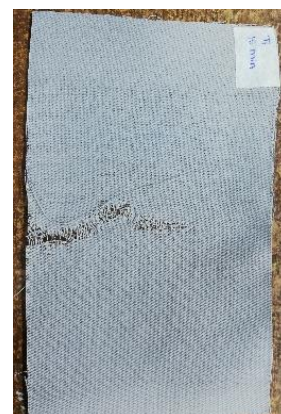
Figura 33. Probeta de trama sometida a 15 min de ozonización, estado seco.
