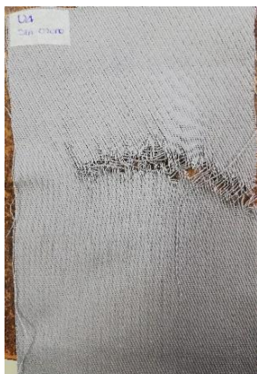
Figura 50. Probeta de urdimbre sometida a 0 min de ozonización en estado húmedo, gabardina 1.
