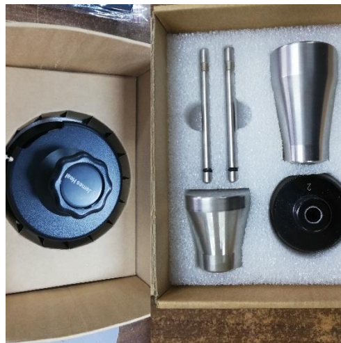
Figura 66. Selección del troquel especificado por la norma ISO 12947-2.
