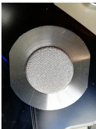
Figura 92. Muestra sometida a 65 min de ozonización, prueba de resistencia a la abrasión en el armazón.
