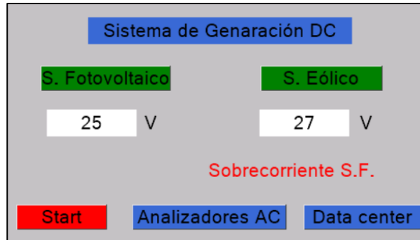
Fig. 52: Sobrecorriente S. Fotovoltaico. Fuente: El Autor.
