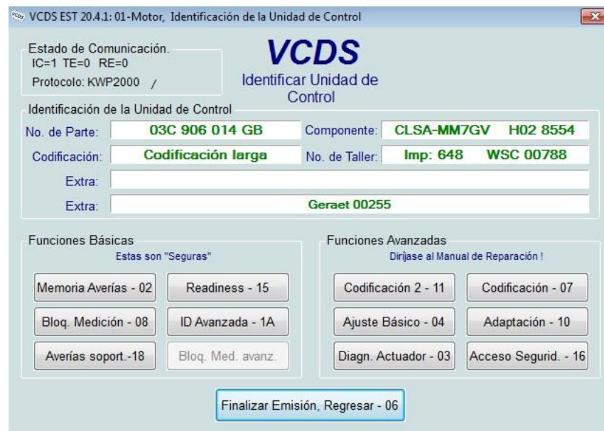
Figura 2. 14 Codificación unidad de control
