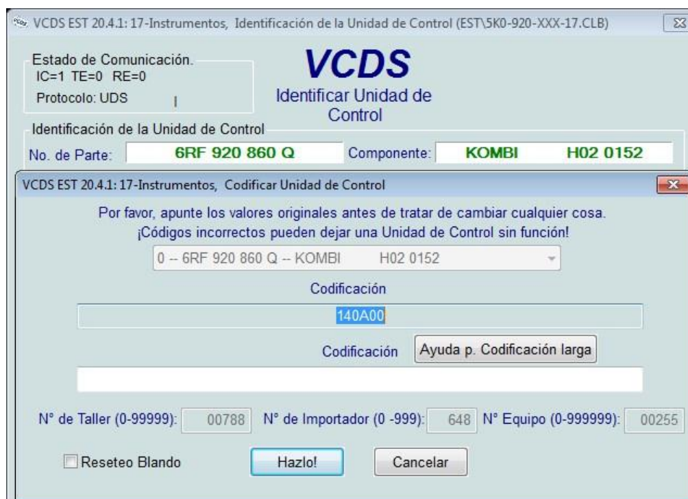
Figura 3. 4 Codificación original tablero
