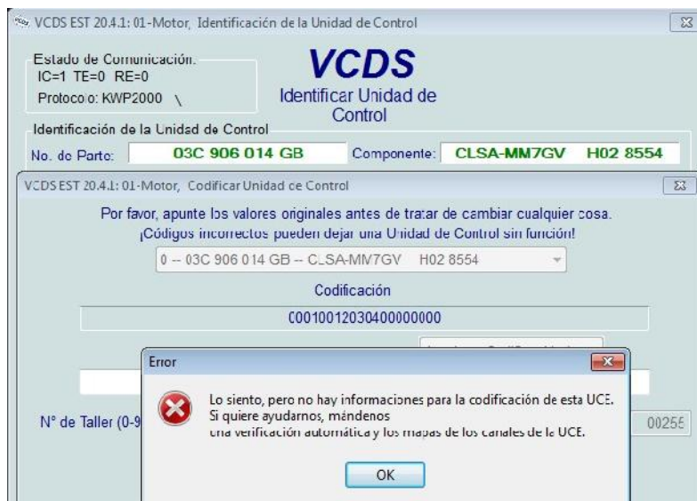
Figura 3. 2 Fallo de comunicación ECU
