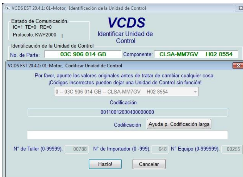
Figura 3. 1 Codificación original ECU
