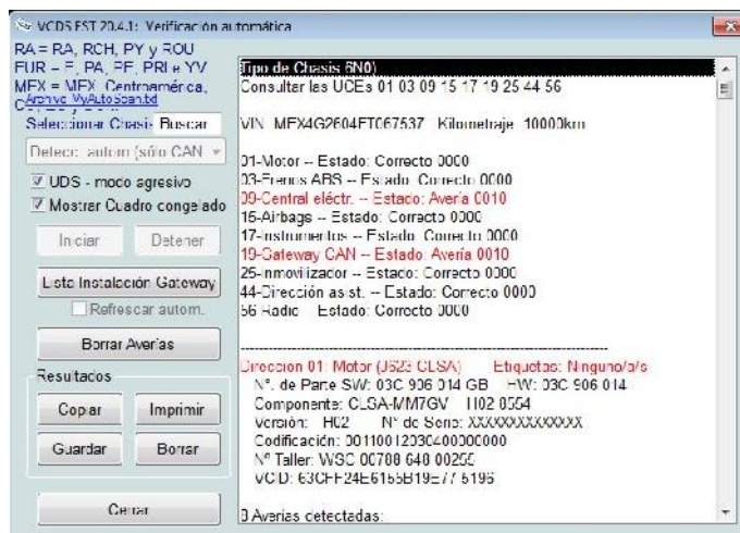
Figura 2. 12 Verificación automática VCDS
