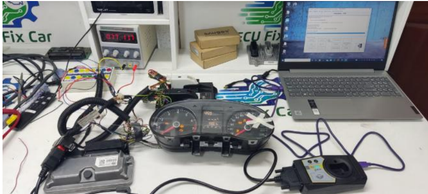
Figura AI 3 Lectura de Microprocesador
