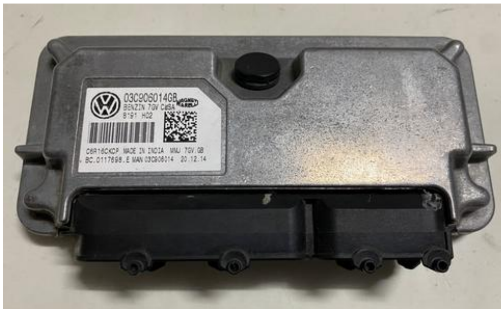
Figura 2. 3 Unidad de control
