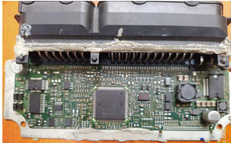
Figura 2. 18 Componentes de la unidad de control
