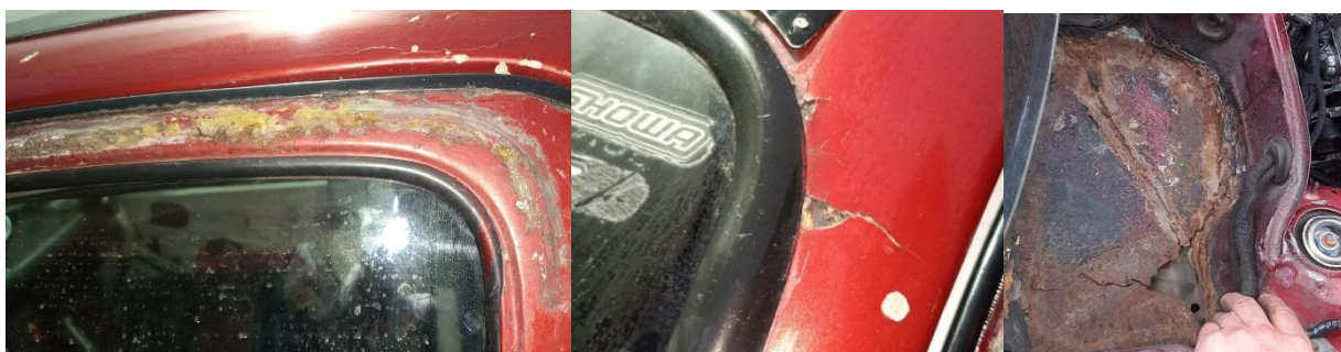
Figura 21 Pintura y carrocería en mal estado.
