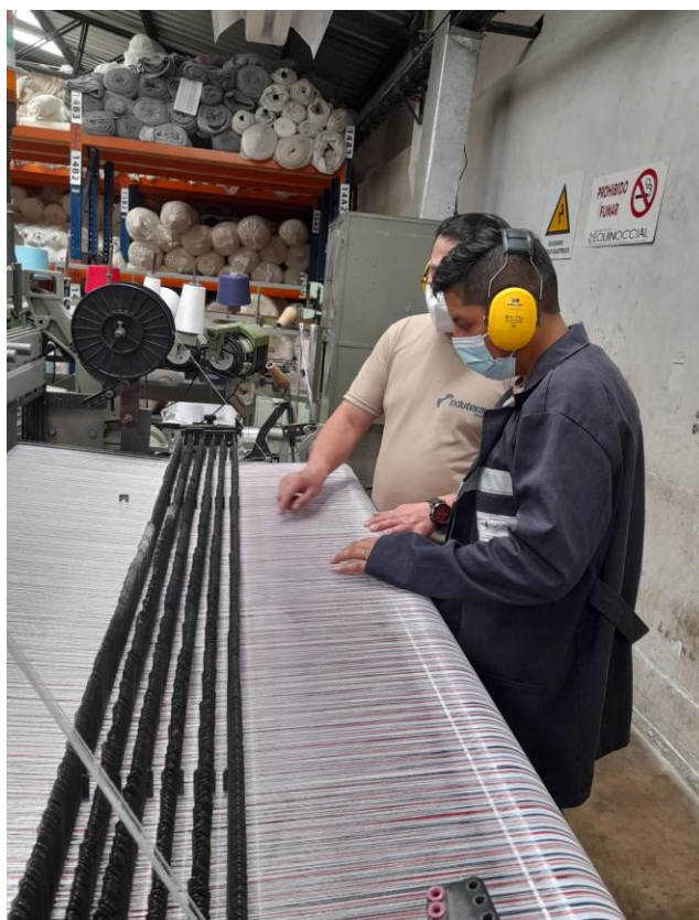
Anexo 14 Revisión de hilos de urdimbre en el telar 5 junto al operador.
