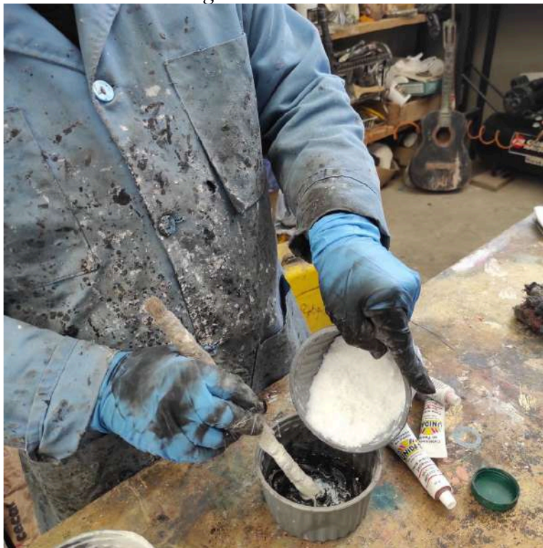
Figura 22. Adición de Aerosil a la Masilla Mustang
