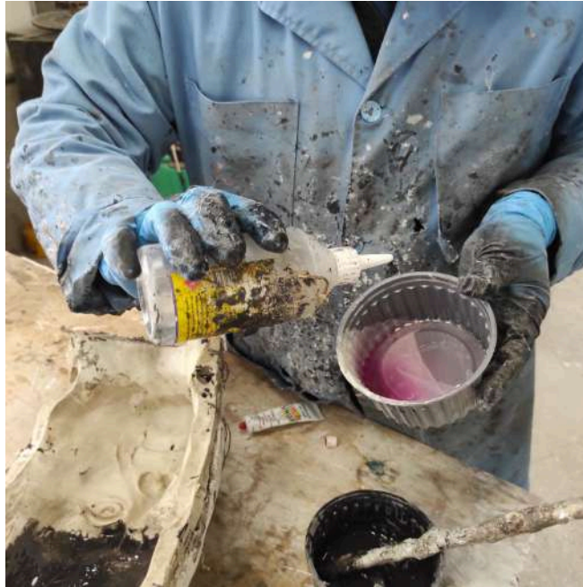
Figura 30. Aplicación de la Resina sobre la primera capa de Fibra de Vidrio
