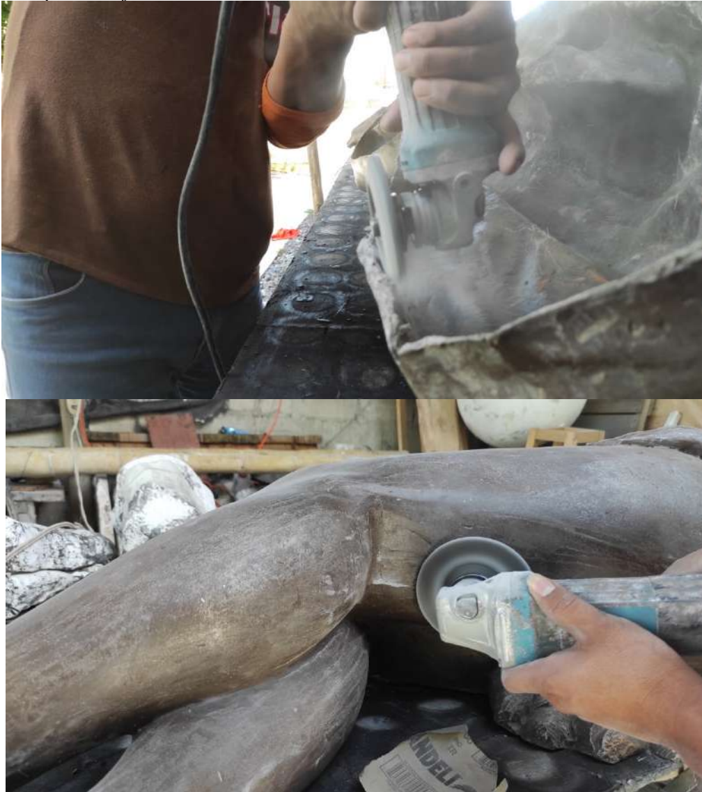
Figura 40. Pulido de la pieza de fibra de vidrio
