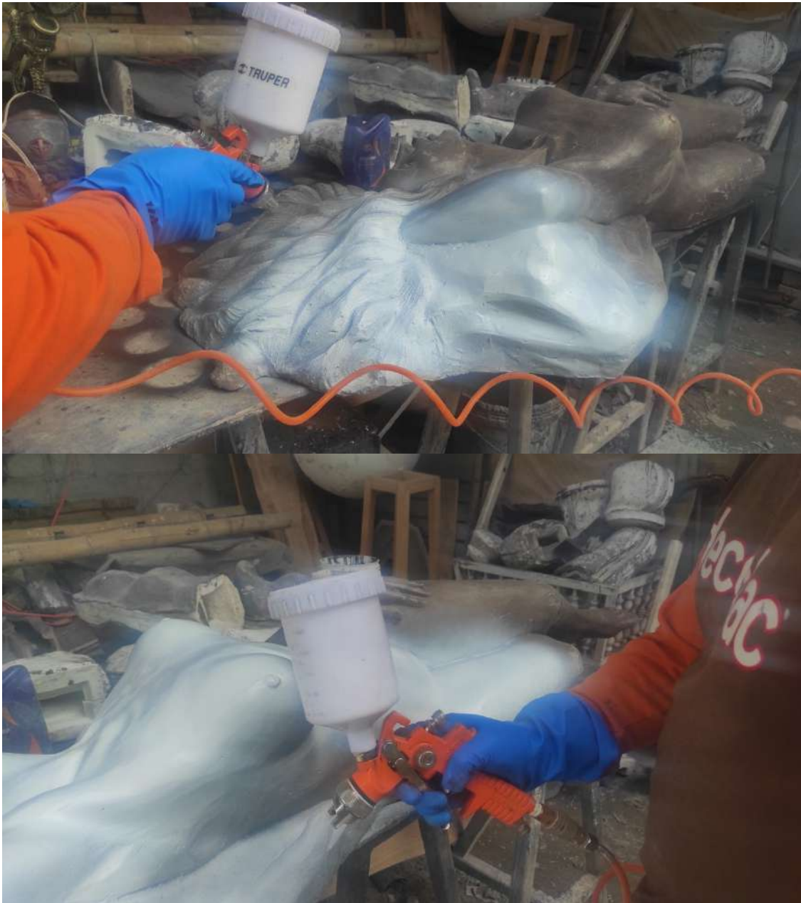
Figura 42. Aplicación de la Pintura de Poliuretano
