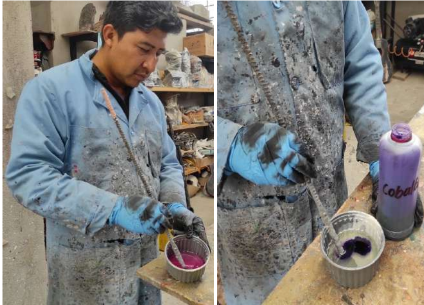
Figura 19. Aplicación del Cobalto en la Mezcla
