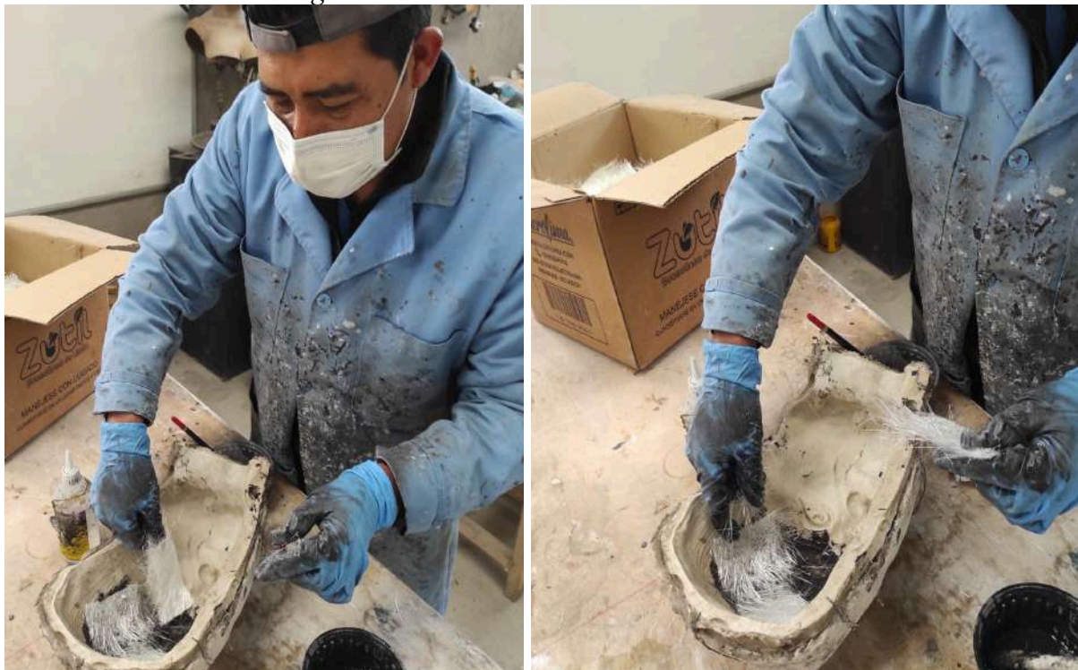
Figura 28. Colocación de la Fibra delgada en la Masilla Seca
