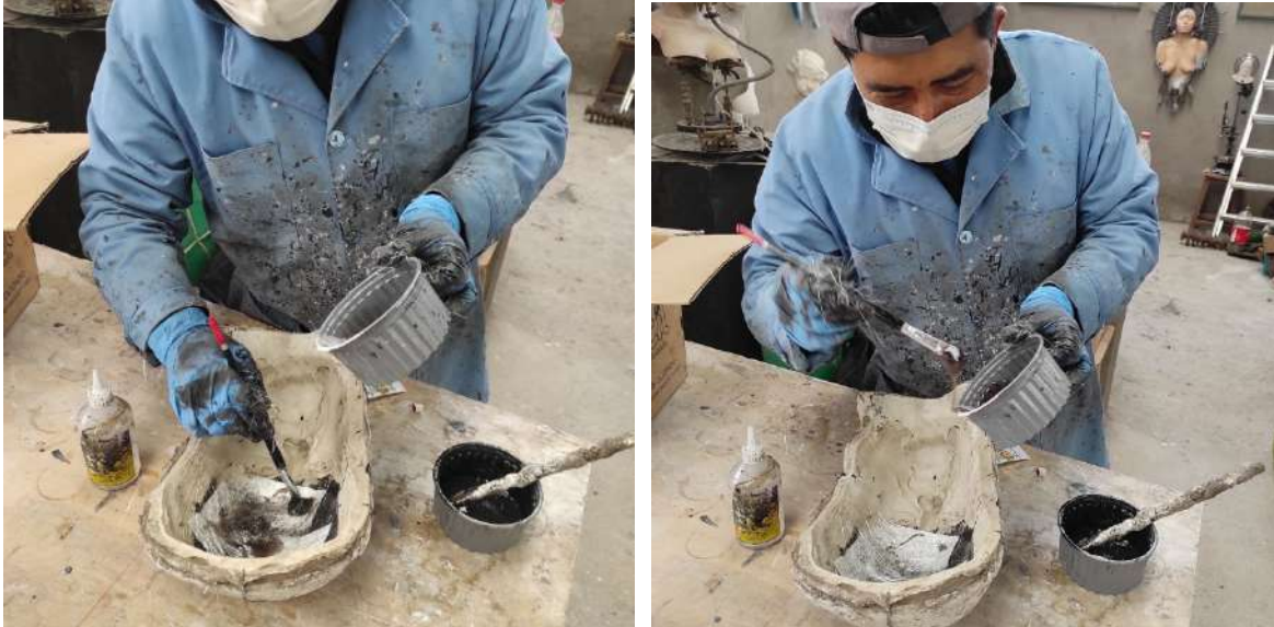
Figura 30. Aplicación de la Resina sobre la primera capa de Fibra de Vidrio
