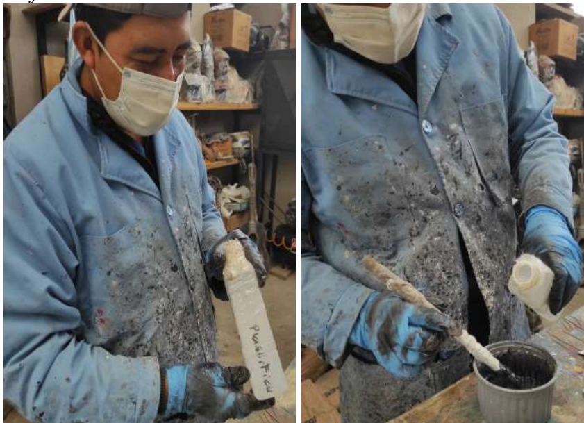
Figura 20. Adición del Plastificante en la Mezcla
