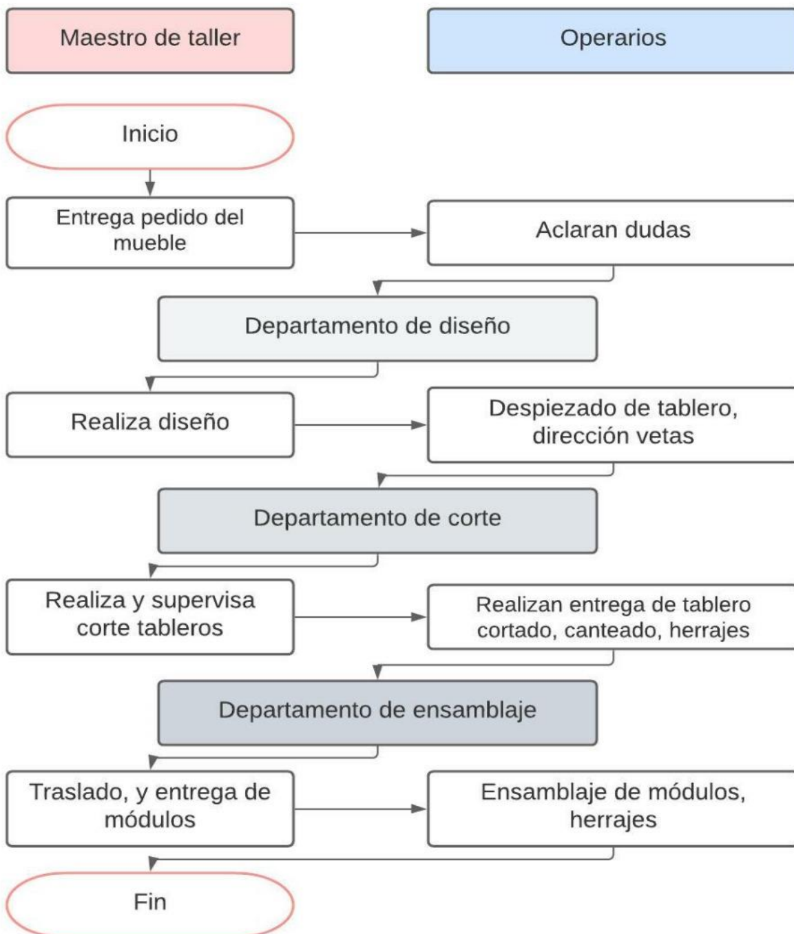
Figura 33: Flujograma de procesos de producción
