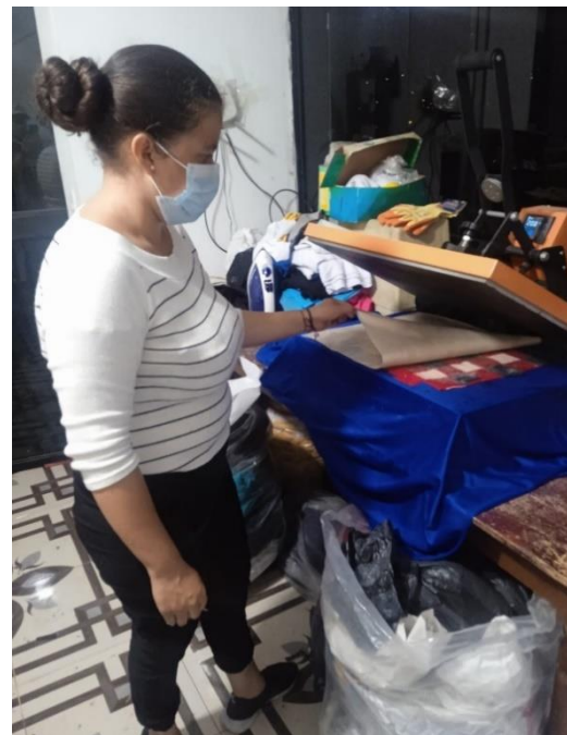
Anexo 11. Ingresar la muestra a la plancha transfer y obtención del laminado. Fuente: Autor
