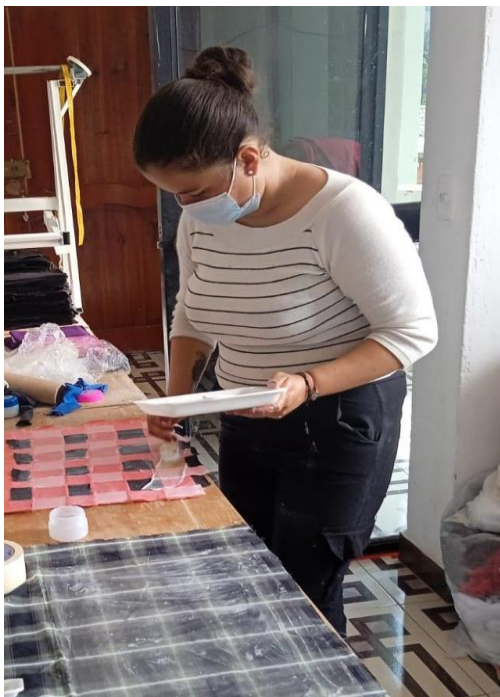
Anexo 10. Colocar los desperdicios de la confección y recubrirlos con la mezcla. Fuente: Autor
