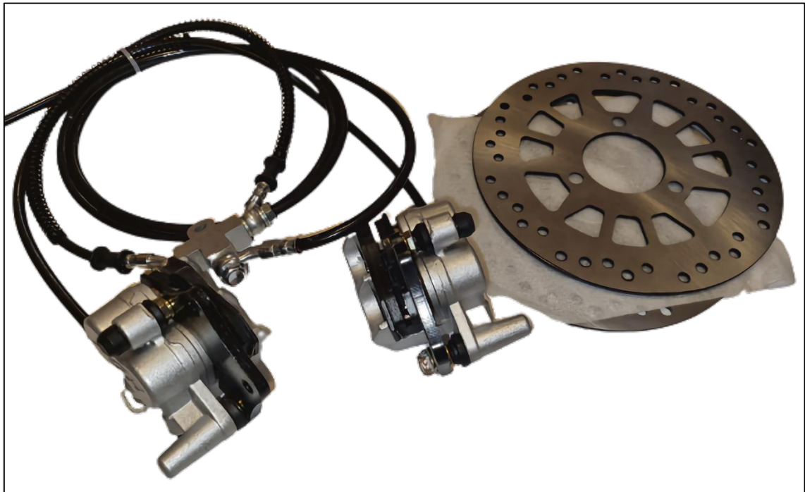
ANEXO IX Sistema de dos unidades de freno de disco posterior
