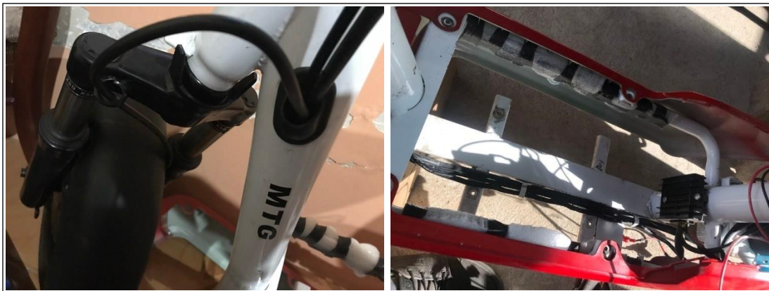
Figura 45: Cableado interno del sistema
