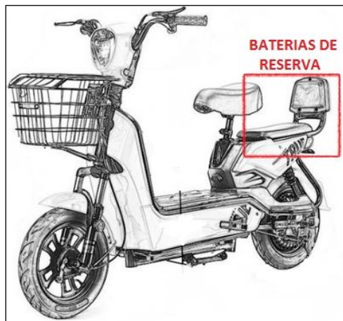
Figura 30: Ubicación de caja para baterías
