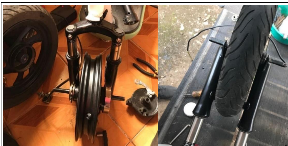
Figura 43: Modificación del eje central de la rueda frontal
