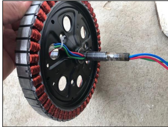
Figura 44: Modificación del cableado interno del motor
