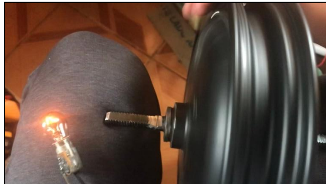
Figura 42: Verificación del funcionamiento en modo generador
