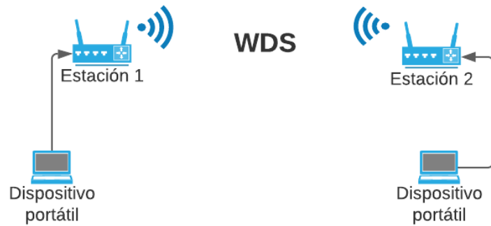
Figura 36. Red WDS modo puente. (Simal, 2011)
