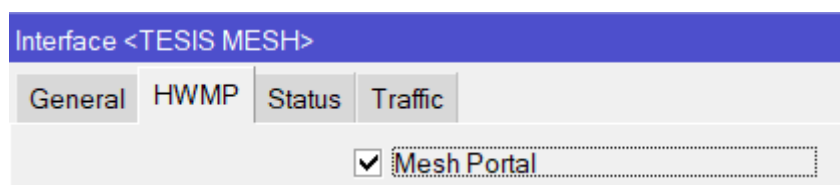
Figura 47. Habilitación al nodo principal como Mesh Portal
