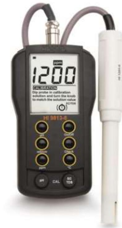
[Nota. Esta Figura se reprodujo de la Ficha Técnica del Producto Medidor portátil de temperatura y pH/EC/TDS](#)
