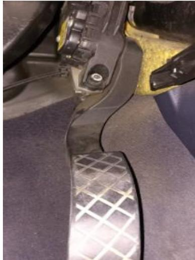
**Figura 74.** Acelerador electrónico
