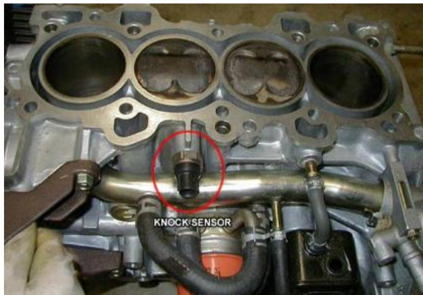
**Figura 36.** Ubicación del sensor de detonación (KS)
