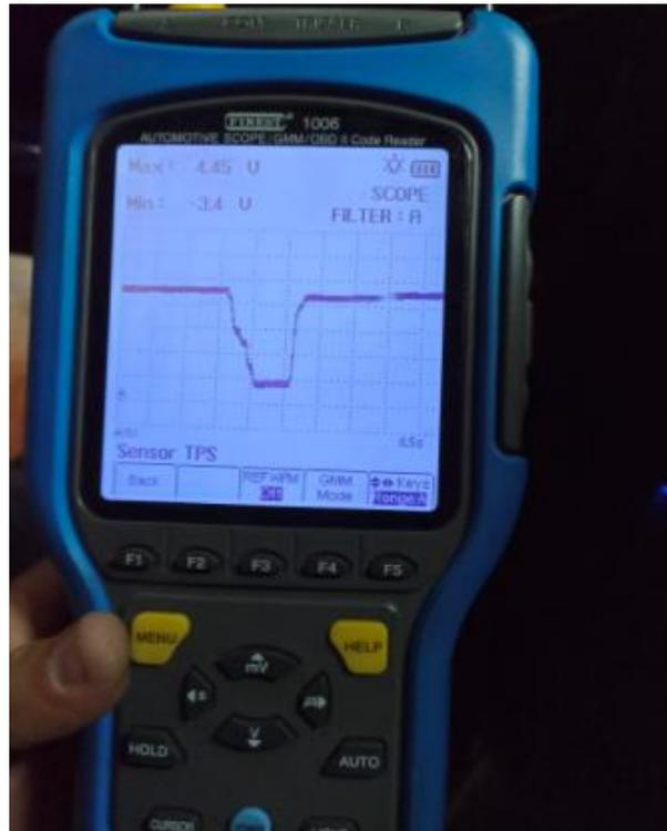
**Figura 77.** Señal del sensor 2 del actuador electrónico del cuerpo de aceleración
