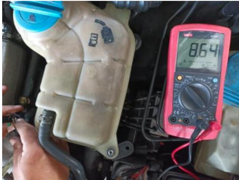
**Figura 70.** voltaje de alimentación del sensor ECT
