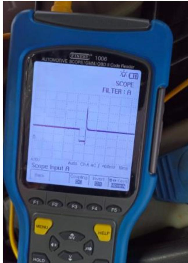
**Figura 85.** Señal de activación del inyector 1
