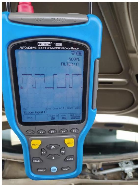
**Figura 55.** Oscilograma del sensor CMP
