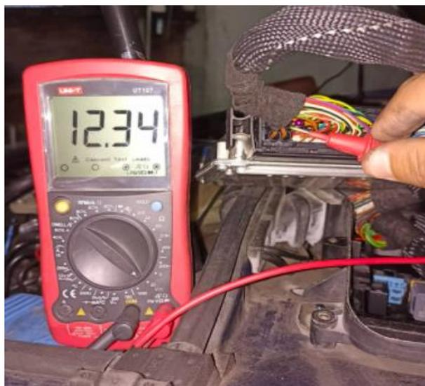
**Figura 50.** voltaje de ignición en el pin 3 de la ECM
