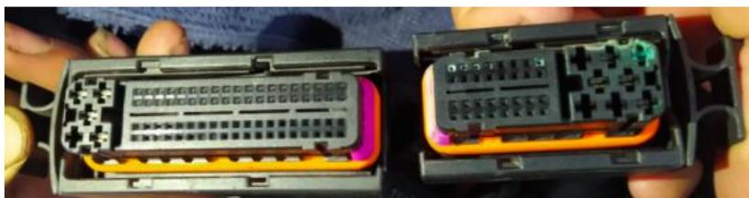
**Figura 48.** Vista del conector del arnés de cables de 121 pines
