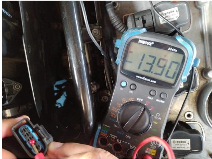
**Figura 62.** Voltaje de alimentación del sensor MAF por batería
