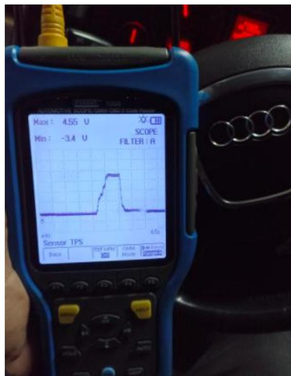
**Figura 78.** Señal del sensor 1 del actuador electrónico del cuerpo de aceleración
