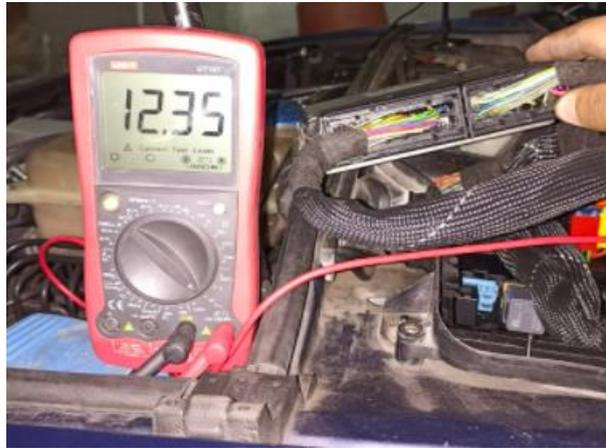
**Figura 49.** voltaje de batería en el pin 62 de la ECM
