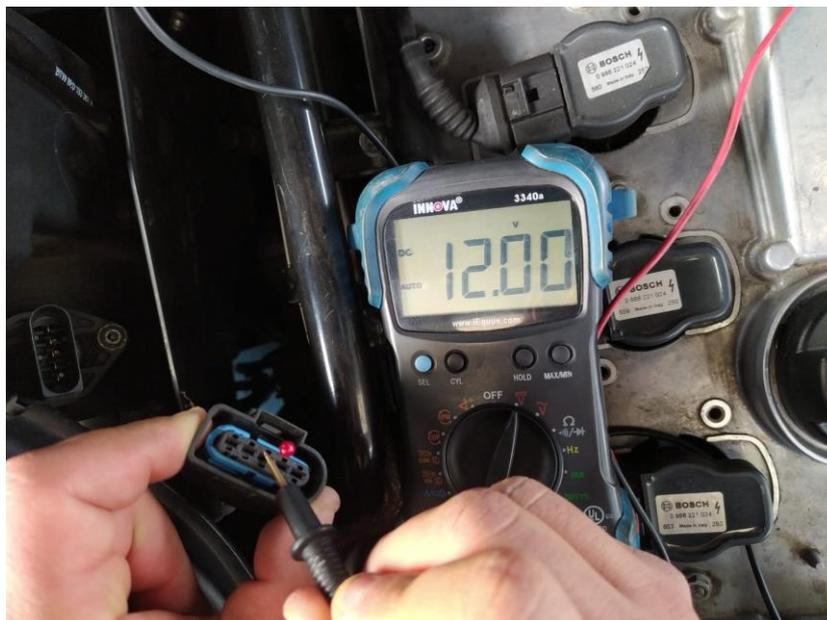
**Figura 61.** Tierra del sensor MAF
