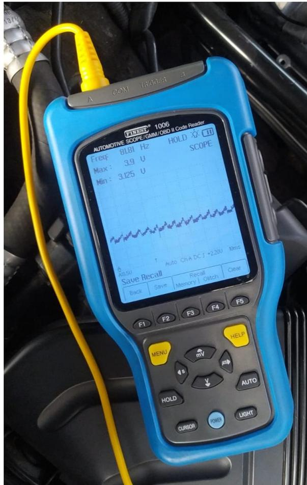
**Figura 64.** Señal del sensor MAF a plena carga
