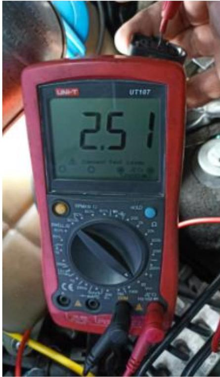
**Figura 80.** Voltaje de alimentación de sensor de oxígeno
