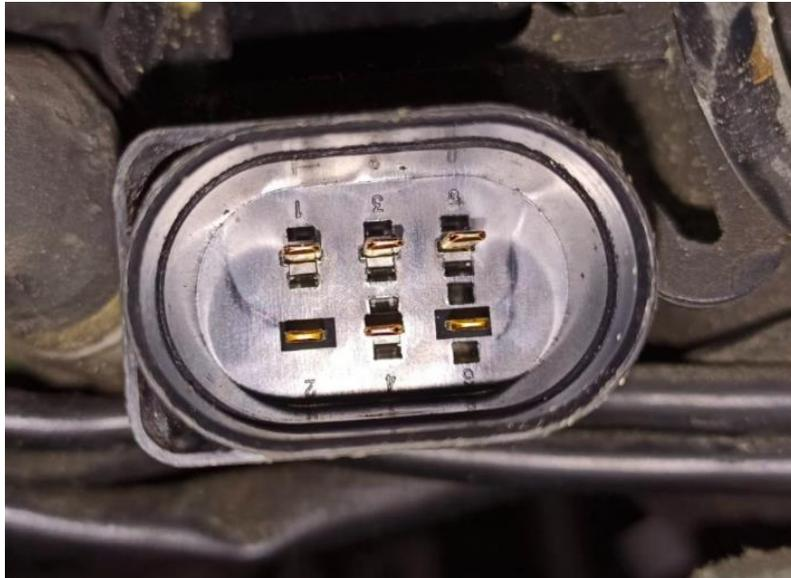
**Figura 79.** Pines del sensor de oxígeno
