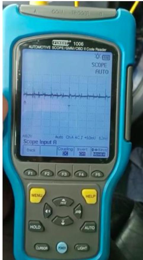
**Figura 99.** Oscilograma de electroválvula recirculación de aire de admisión N 249
