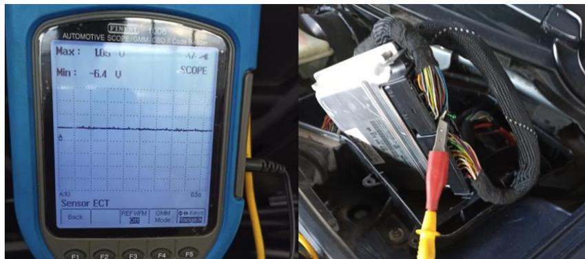
**Figura 69.** el oscilograma representa la señal del sensor ECT tomada en la ECM a 90°C.
