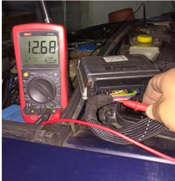
**Figura 51.** voltaje del relevador de la ECM en el pin 121
