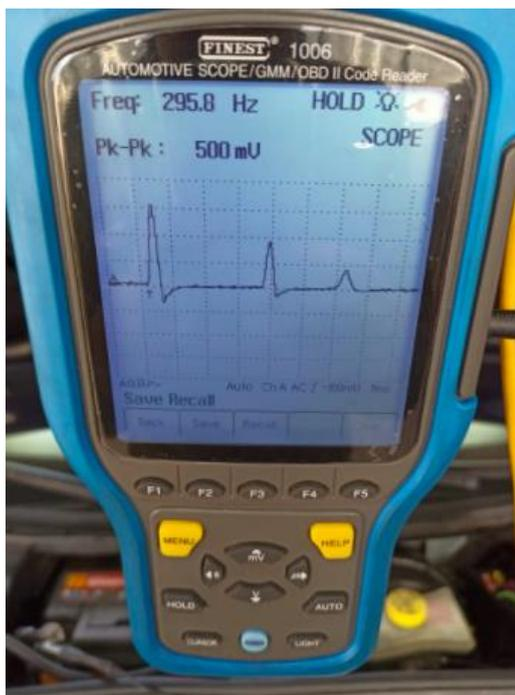
**Figura 67.** oscilograma del sensor KS 2
