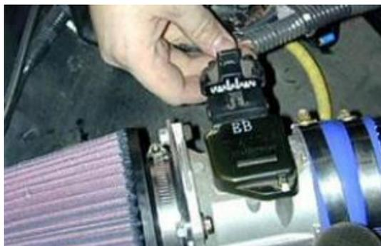
**Figura 28.** Sensor de entrada de aire (MAF)
