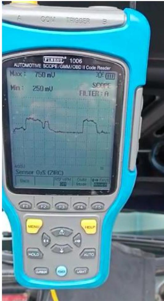
**Figura 84.** Señal del sensor de oxígeno de zirconio G 130
