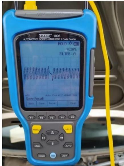
**Figura 58.** Oscilograma del sensor CKP
