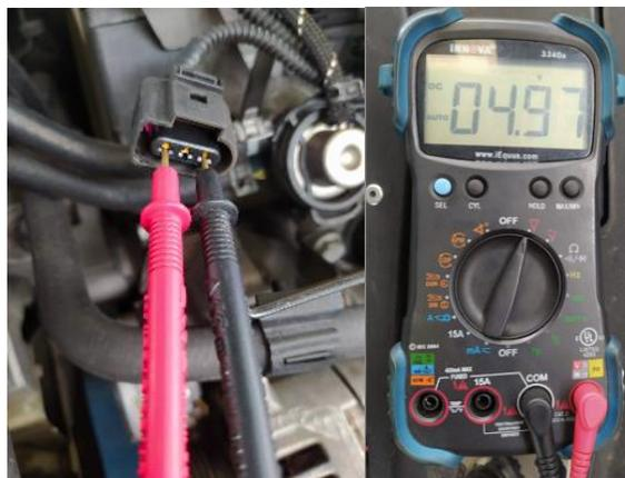
**Figura 53.** Medición de alimentación sensor CMP
