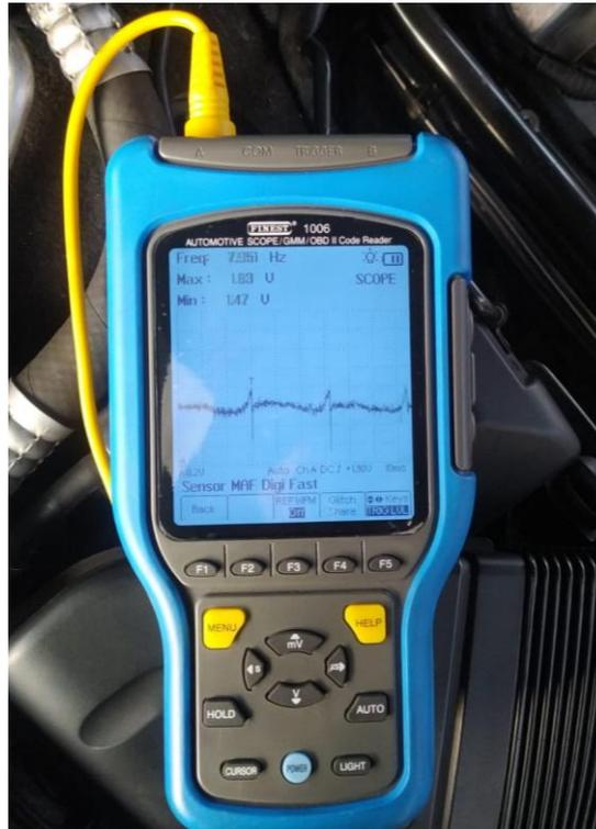
**Figura 63.** Señal del sensor MAF en ralentí
