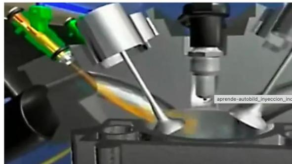
**Figura 4.** Inyección indirecta
