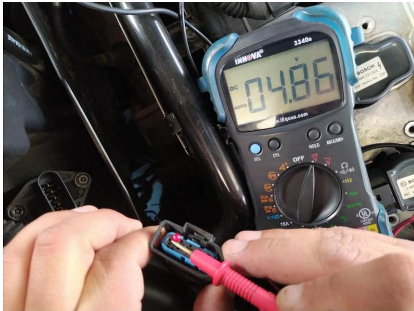
**Figura 60.** Voltaje de alimentación de la ECM
