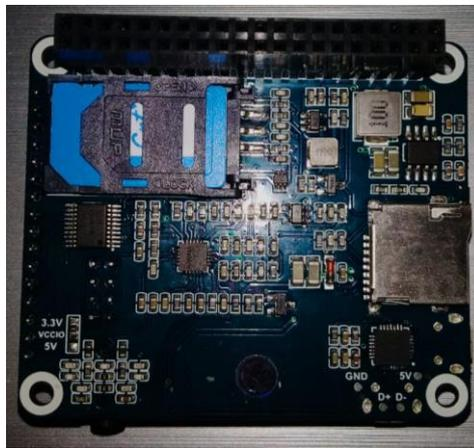
Figura 31. Conexión SIM de operadora móvil en módulo
