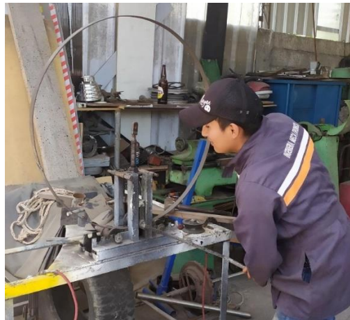
Figura 56: Construcción de anillos externos
