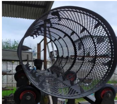
Figura 60: Trómel con ganchos y cuchillas alineados.
