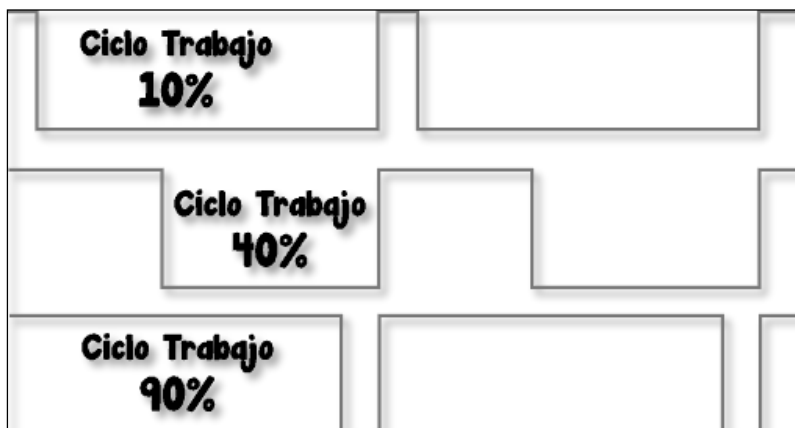
Fig. 11 Diagrama de técnica de modulación por ancho de pulso (PWM) con distintos Duty Cycle.
