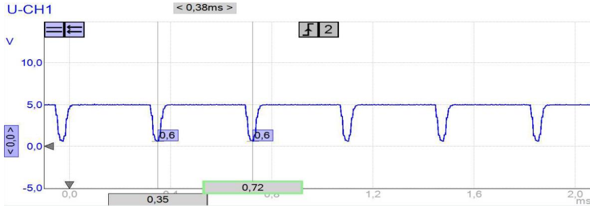
Figura 3.22 Oscilograma de sensor MAF a 2500 rpm
