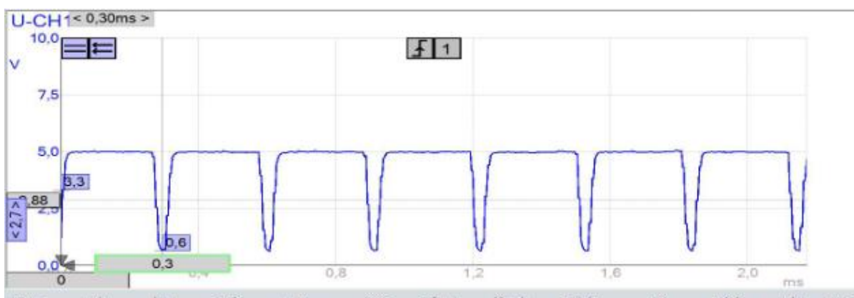
Figura 3.45 Oscilograma sensor MAF con simulación de fallo
