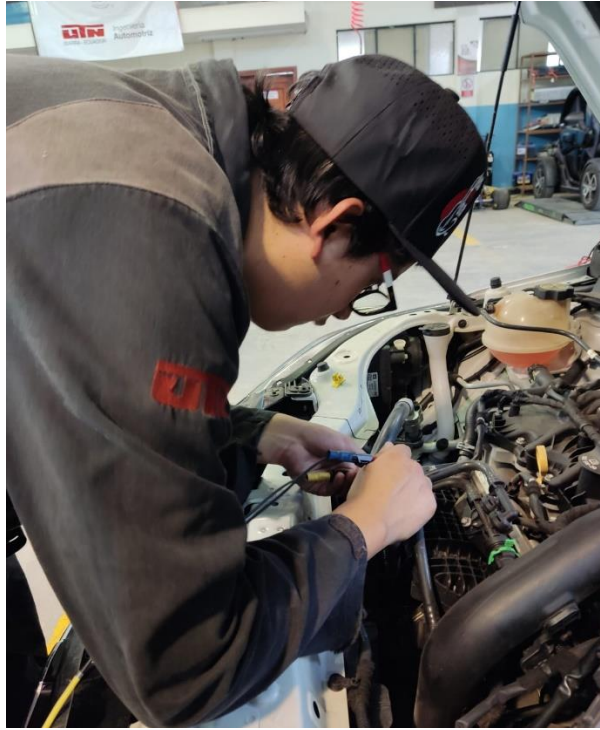
Anexo 3 Conexión de osciloscopio a sensores del vehículo
