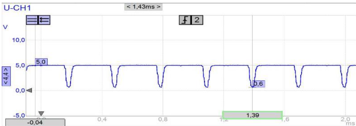
Figura 3.14 Oscilograma de sensor MAF con motor a ralentí
