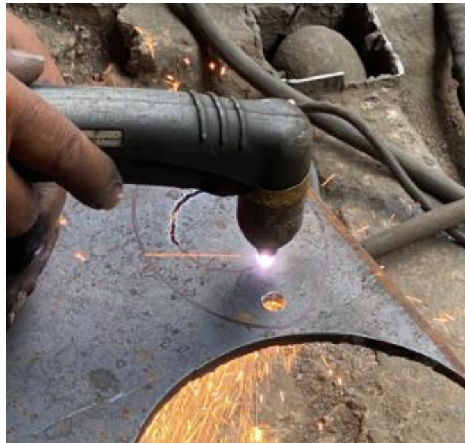
FIGURA AI.10 Corte de bridas por plasma
