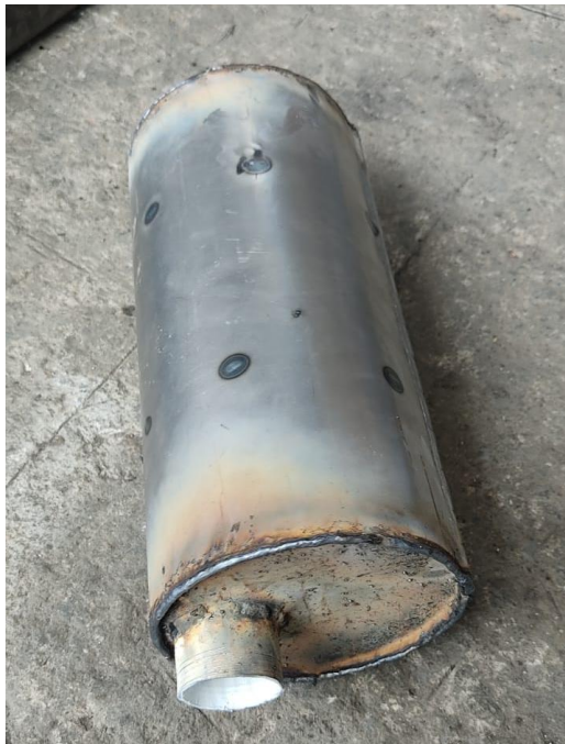
FIGURA 3.25 Suelda de los conductos con el silenciador
