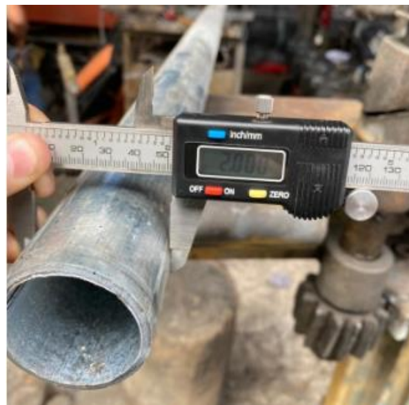
FIGURA AI.2 Medición de tuberías
