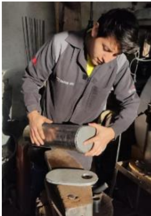
FIGURA AI.11 Ensamblaje de silenciadores
