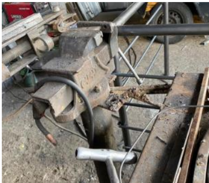
FIGURA 3.19 Tornillo de banco para sujetar los tubos de corte
