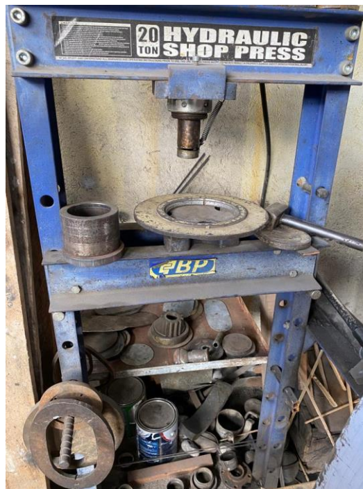
FIGURA 3.17 Prensa para crear las placas deflectoras de los silenciadores
