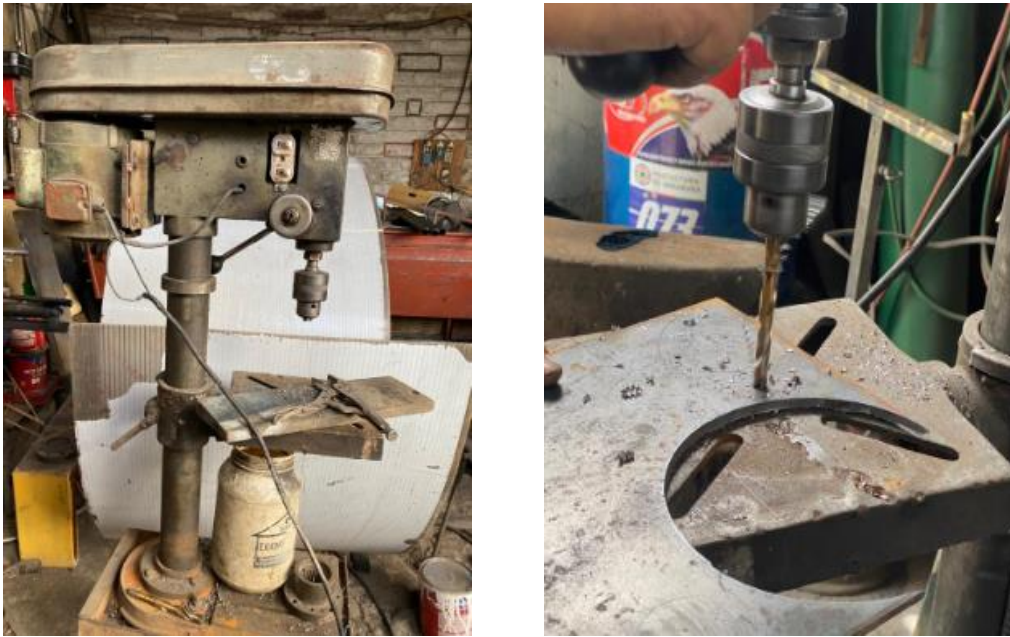
FIGURA 3.21 Taladro pedestal para perforación de tubos
