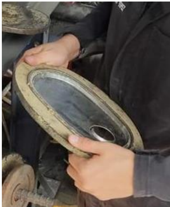
FIGURA 3.18 Molde para las tapas de los silenciadores
