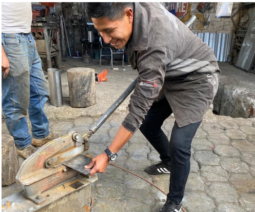
FIGURA 3.15 Corte de lámina por cizalla de banco
