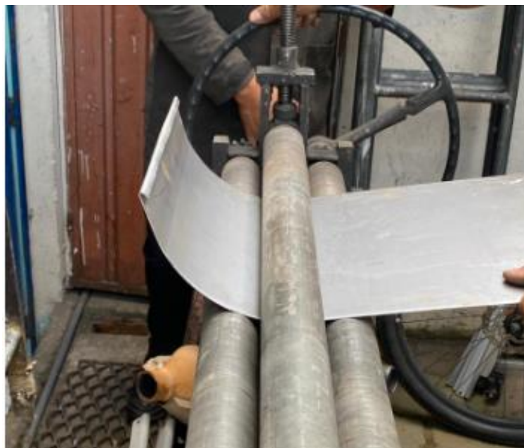
FIGURA AI.7 Barolado del silenciador ovalado híbrido
