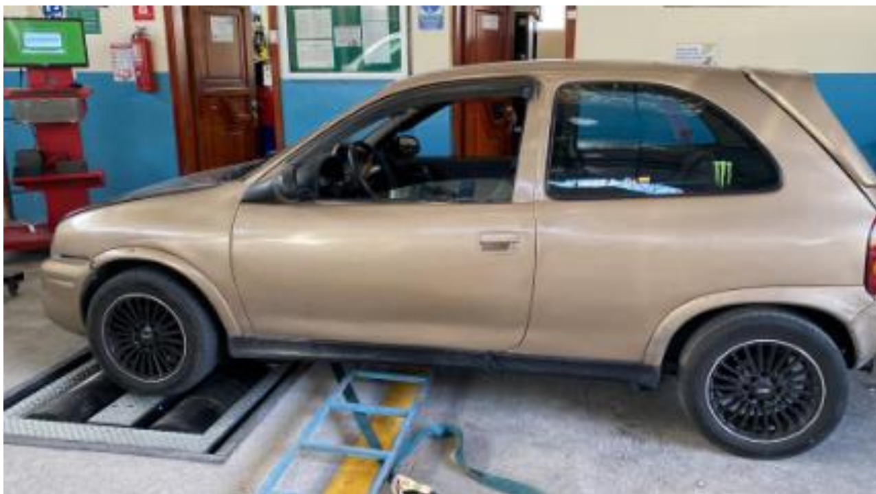
FIGURA AIII.5 Prueba Dinamométrica en vehículo Corsa Wind 1.4L
