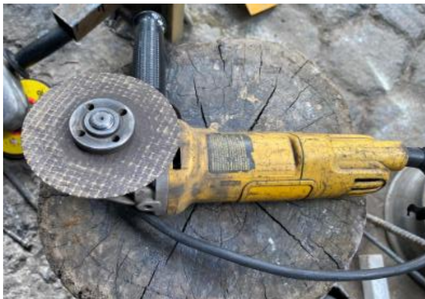
FIGURA 3.20 Amoladora con disco de corte para tubos
