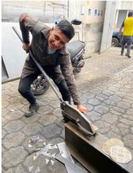
FIGURA AI.3 Proceso de corte de los moldes de las tapas
