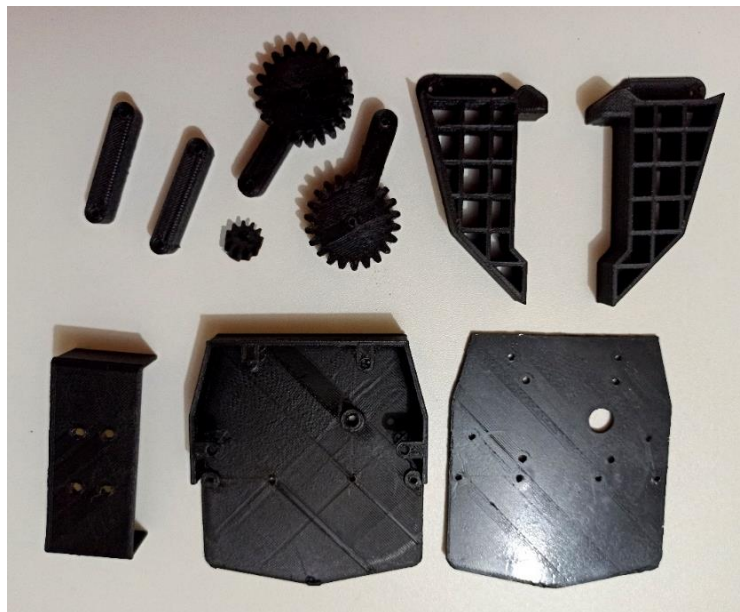
Figura 18. Piezas impresas en material PLA+.
