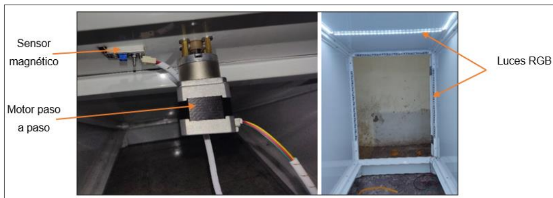
Figura.3.4. Conexiones de los elementos eléctricos y electrónicos.
