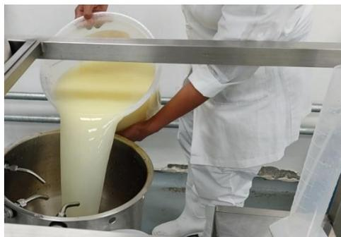
**Figura 14.** Carga de lactosuero en el tanque de alimentación.
