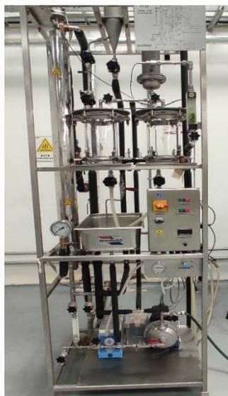
**Figura 18.** Evaporador de película ascendente.
