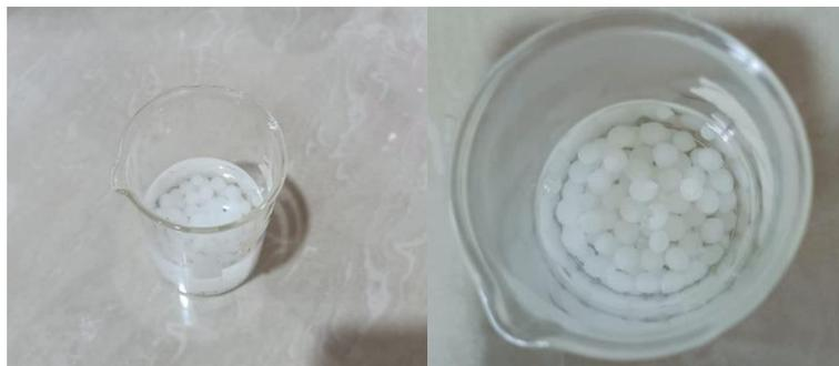
**Figura 23.** Gelificación de las perlas de alginato de sodio.
