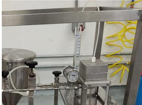
**Figura 17.** Recuperación del permeado de lactosa a través del equipo de filtración tangencial.
