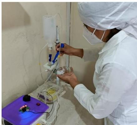
**Figura 25.** Colocación de las perlas de alginato en el reactor de lecho empacado a flujo previo a la reacción enzimática.
