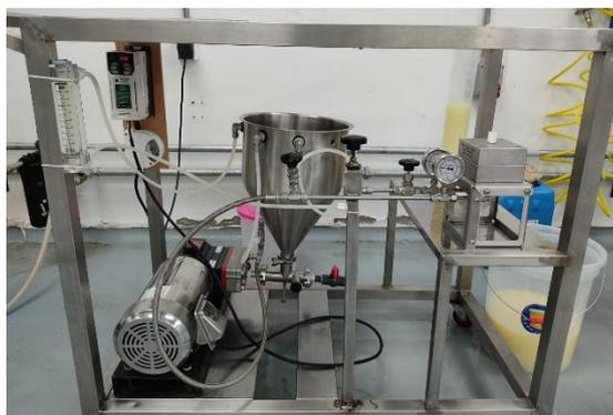
**Figura 12.** Unidad de filtración de flujo cruzado.
