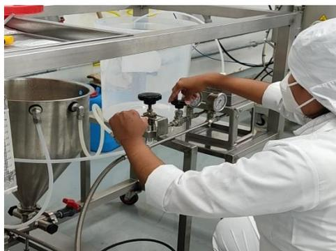
**Figura 15.** Apertura de las válvulas del sistema al finalizar el trabajo en el equipo.
