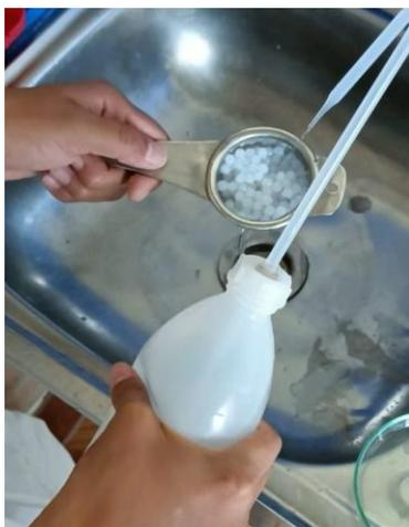
**Figura 24.** Filtrado y lavado de las perlas de alginato.
