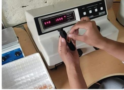
**Figura 27.** Cuantificación de azúcares reductores por espectrofotometría.
