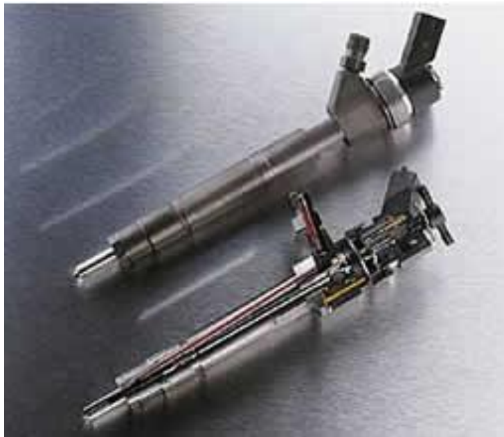
Figura 1.6 Inyector con válvula electromagnética
