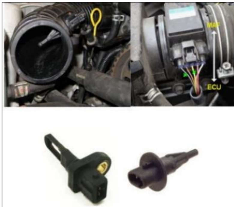
Figura 1.13 Ubicación y estructura del sensor IAT (Calsin Heredia & Rodríguez Zinanyuca, 2015)
