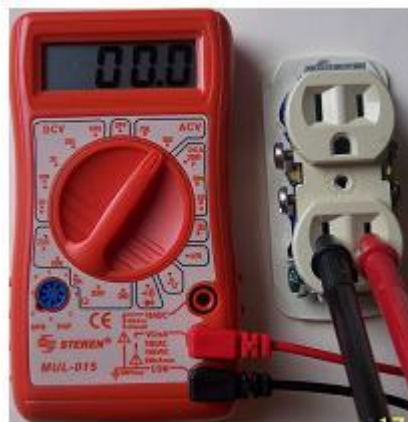
Figura 18. Medición de la corriente con el uso de multímetro. (S.A., Electricidad básica. Fundamentos básicos sobre electricidad., S.F.)
