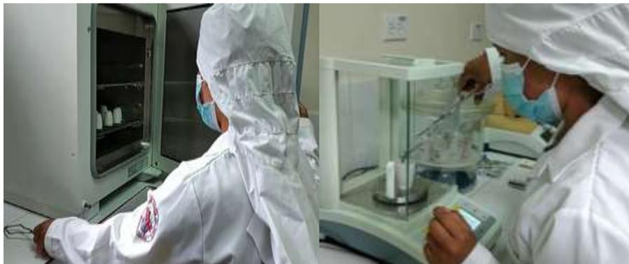
Figura 21. Determinación de humedad
