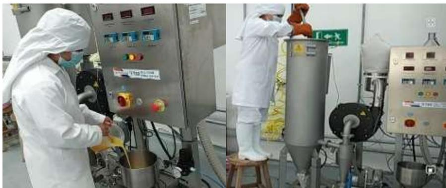
**Figura 17.** Atomizado de la disolución
