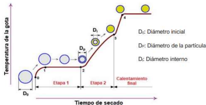
Figura 8. Perfil del Secado de una Gota Durante el Secado
