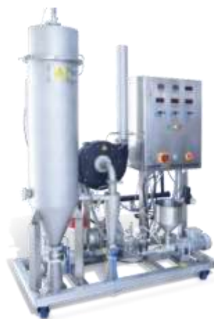
Figura 9. Atomización Spray Dryer Ibarz & Barbosa-Cánovas (2014)
