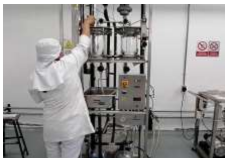
Figura 20. Concentración a Vacío
