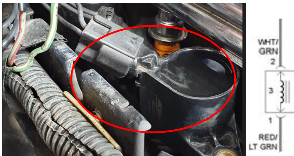
Figura 2.6 Ubicación y diagrama eléctrico bobina cilindro uno
