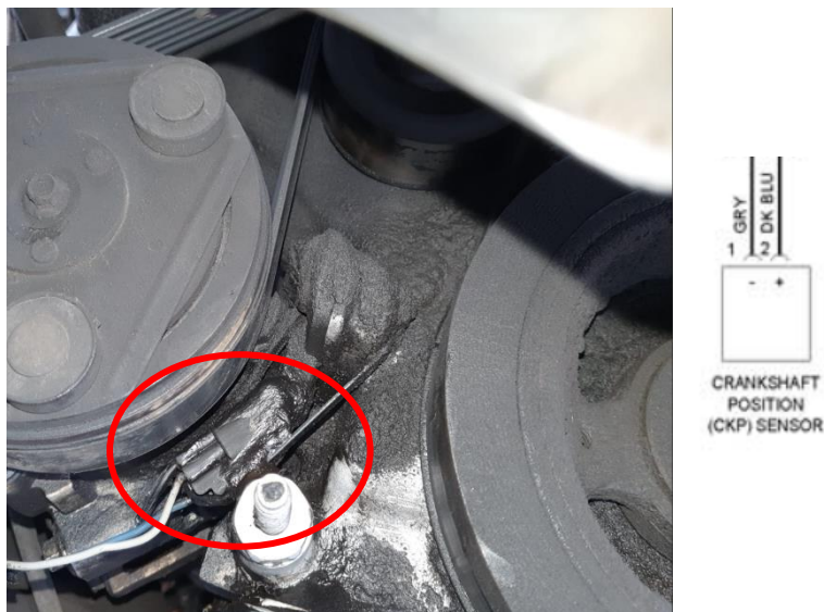
Figura 2.4 Ubicación y diagrama eléctrico sensor CKP
