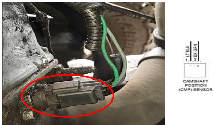
Figura 2.5 Ubicación y diagrama eléctrico sensor CMP
