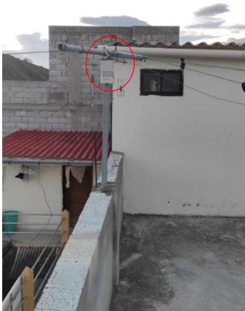
Anexo 6m. Instalación de pluviómetro en Pimampiro
