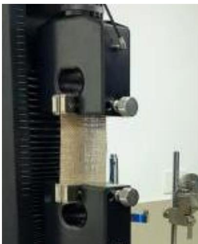
**Figura 26.** Ensayo de tracción.
