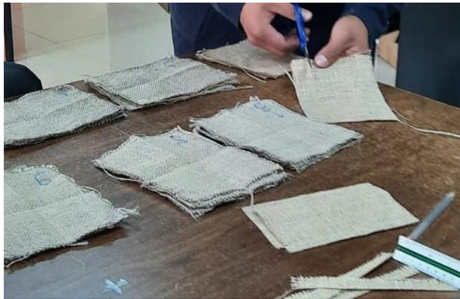
**Figura 24.** Corte de juegos de 5 probetas
