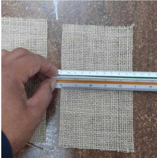
**Figura 23.** Medida de los juegos de probetas.
