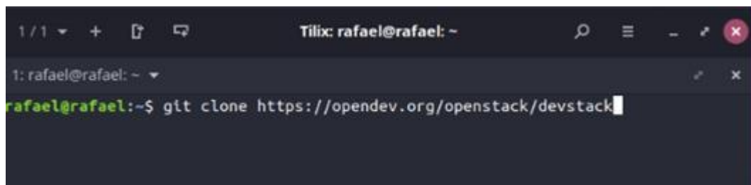
Figura 36. Comando 1. Descarga de plataforma DevStack
