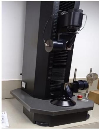
**Figura 28:** Dinamómetro Titan 5 modelo 1410
