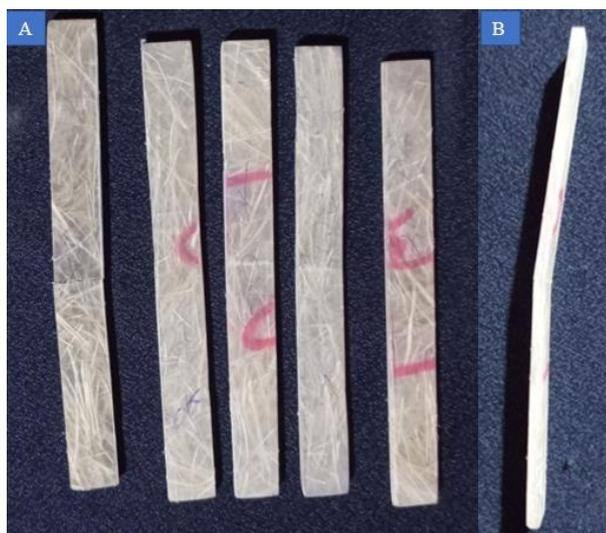
**Figura 56:** Refuerzo de abacá 30mm A. Vista frontal B. Vista lateral
