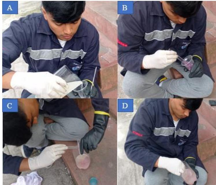
**Figura 41:** A. Agregar resina al catalizador B. Agitar la mezcla C. Adicionar la mezcla al resto de resina D. Agitar toda la resina
