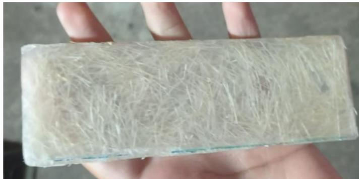
**Figura 47:** Resultado final del laminado con fibra de abacá
