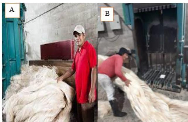
**Figura 13:** A: Pesaje de fibra- B: Compresión de fibra
