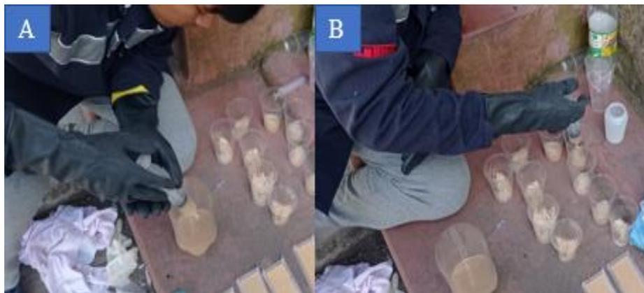
**Figura 44:** A. Medir volumen de resina para probeta B. Adicionar la resina a la fibra
