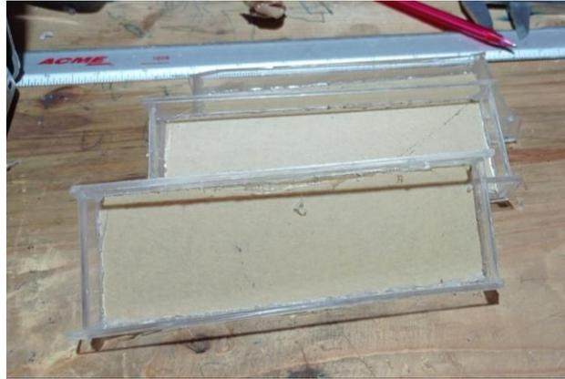
**Figura 38:** Moldes para realizar probetas de ensayo a la tracción
