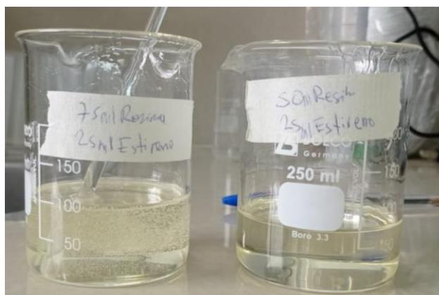
**Figura 32:** Resina de poliéster con estireno en concentración de 75/25 y 66/33
