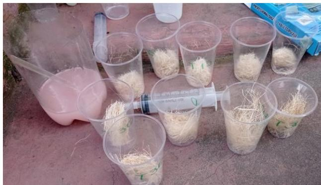
**Figura 42:** Identificar y colocar fibra para realizar la humectación
