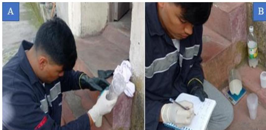
**Figura 39:** A. Medir el volumen de resina B. Registro del peso de resina
