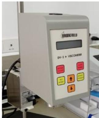
**Figura 26:** Viscosímetro digital Brookfield DV-I Modelo LV DV-I
