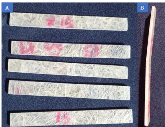
**Figura 55:** Refuerzo de abacá 15mm A. Vista frontal B. Vista lateral
