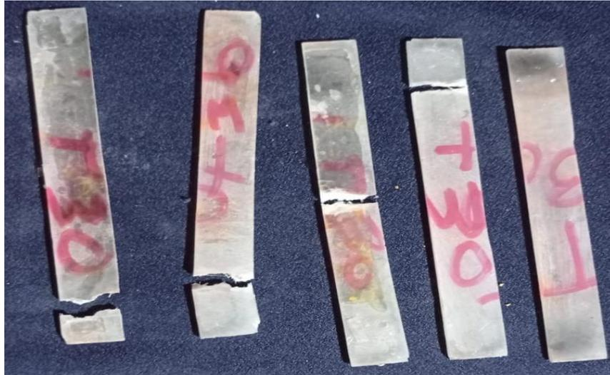
**Figura 53:** Probetas reforzadas con 30mm fibra de vidrio
