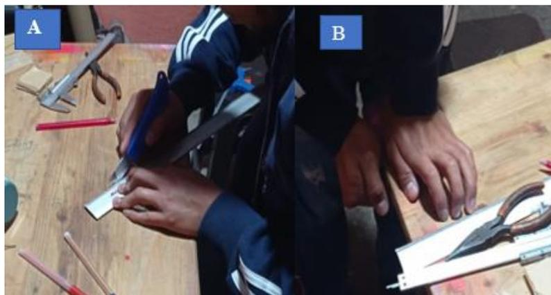
**Figura 36:** A. Repasado con cutter sobre la línea B. Aplicar presión para completar el corte
