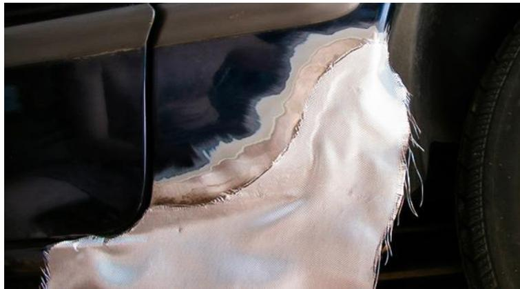
**Figura 16:** Reparación en automotores
