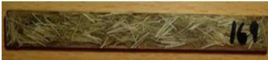
**Figura 3:** Probeta de resina de poliéster y reforzada con fibra de cabuya
