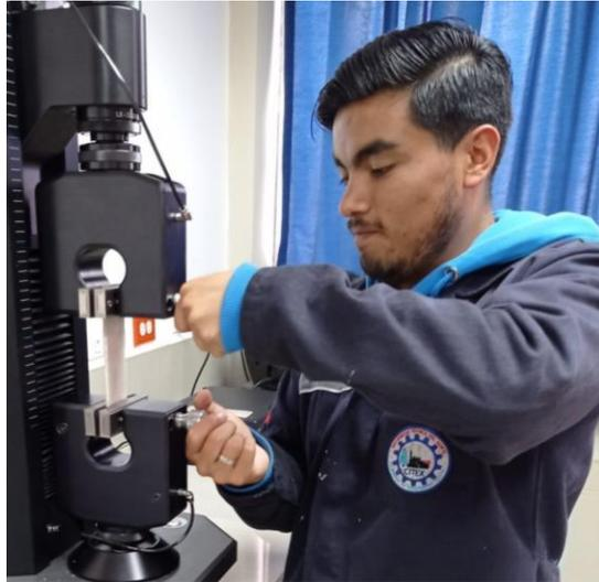
**Figura 49:** Colocación de probetas en el Titan 5 modelo 1410
