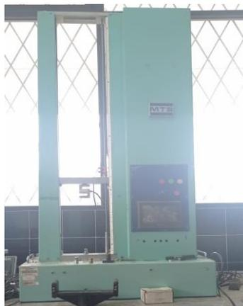
**Figura 29:** Máquina universal de ensayos MTS TK/T50002
