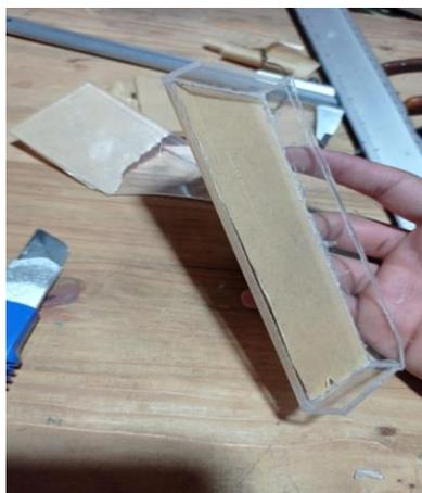
**Figura 37:** Pegado de las caras del molde para probetas de tracción
