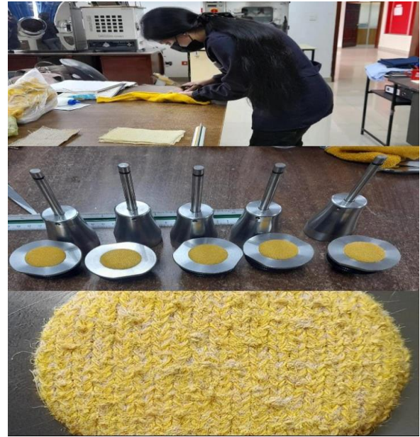
Anexo 6. Corte y colocación de las probetas en el porta muestras
