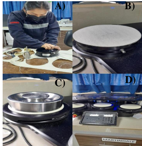
Anexo 2. Preparación Tela abrasiva. A) Cortar la tela abrasiva con ayuda de la cortadora (3 muestras). B) Colocar el filtro sobre la base. C) Peso sobre el filtro. D) Colocamos el anillo, ajustamos y retiramos el peso.
