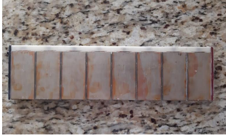
Figura 3.26 Configuración de celdas en módulos defectuosos. Fuente: Autores
