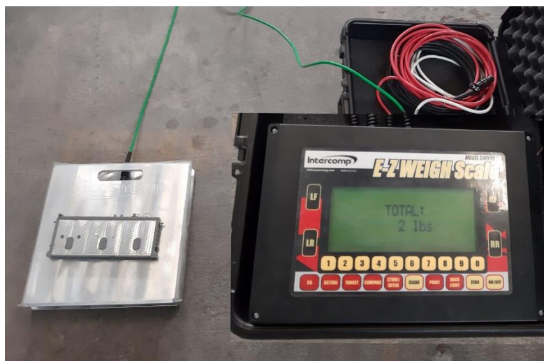
Figura 3.22 Pesaje de módulos de baterías HV
