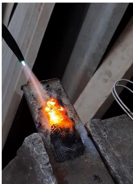
Figura 3.34 Soldadura oxiacetilénica del electrodo negativo. Fuente: Autores
