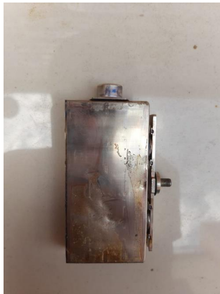
Figura 3.27 Celda de NiMH Toyota Highlander. Fuente: Autores
