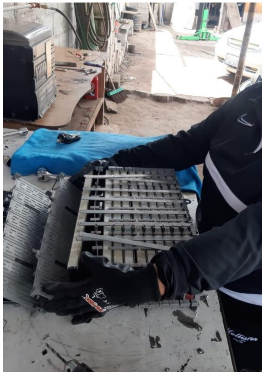
Figura 3.25 Desensamblado de los módulos defectuosos. Fuente: Autores
