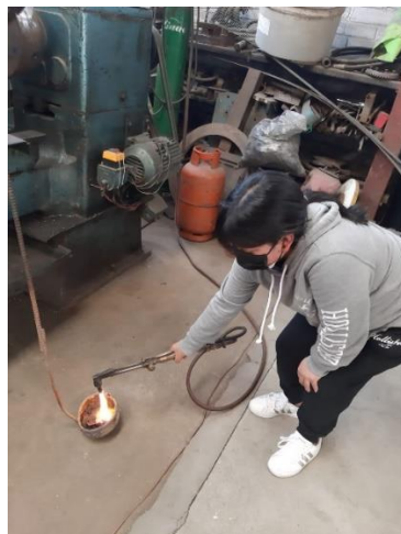
Figura 3.31 Fundición de electrodos por soldadura oxiacetileno.
