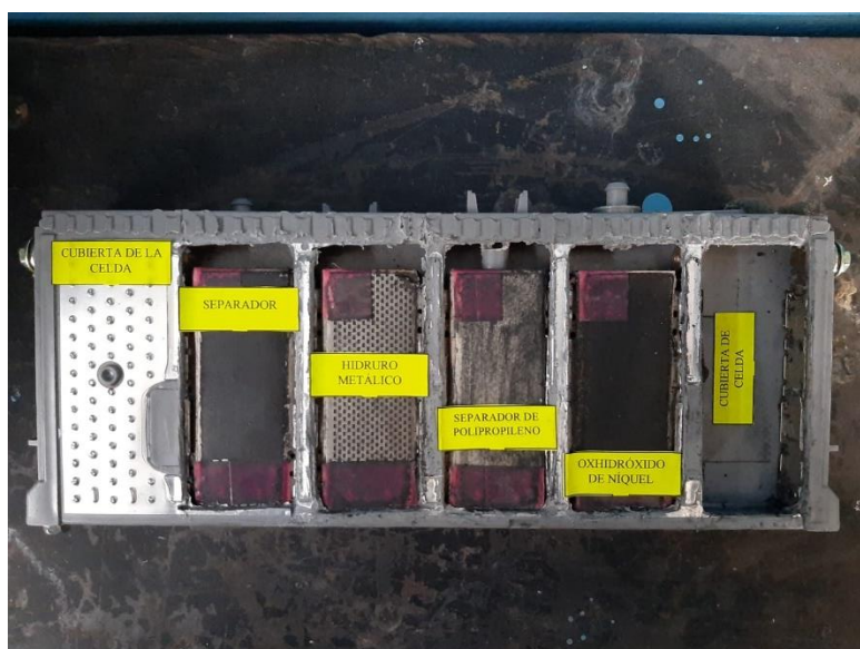
Figura 3.40 Estructura interna de la batería HV Toyota Prius. Fuente: Autores
