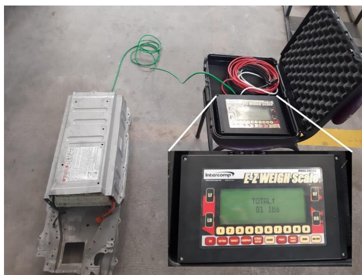
Figura 3.21 Pesaje batería modelo Toyota Prius 3G 2010 Fuente: Autores
