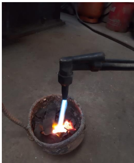
Figura 3.32 Soldadura oxicarburante en electrodos. Fuente: Autores
