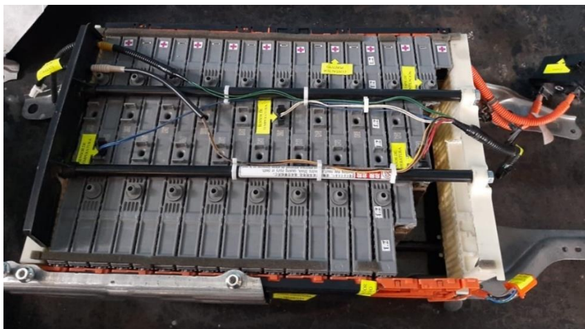
Figura 3.39 Estructura externa de la batería HV Toyota Prius. Fuente: Autores
