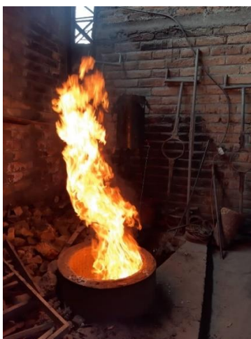
Figura 3.29 Fundición de electrodos mediante horno. Fuente: Autores
