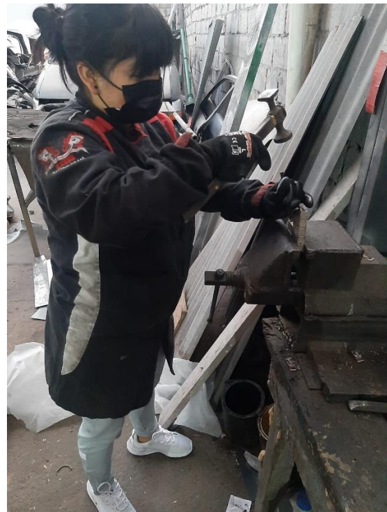
Figura. 6.3 Separación estructura metálica de las celdas
