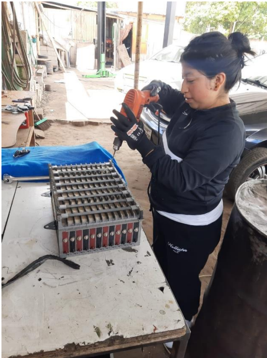
Figura. 6.2 Desarmado de los módulos
