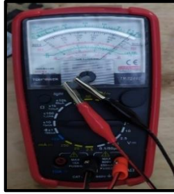
Fig. 32. Calibración del multímetro analógico
