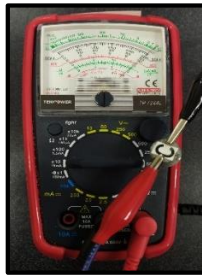
Fig. 33. Medición de resistencia "A" (con recubrimiento)
