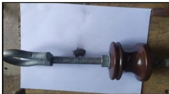
Fig. 25. Residuos de corrosión estructura “B” (Sin recubrimiento)
