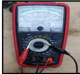
Fig. 35. Medición de resistencia "A" (con recubrimiento)
