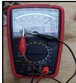
Fig. 34. Medición de resistencia "B" (sin recubrimiento)
