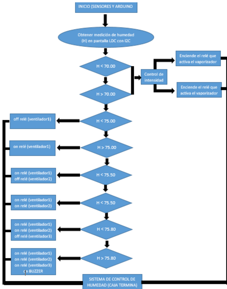
Fig. 9. Sistema de control de humedad
