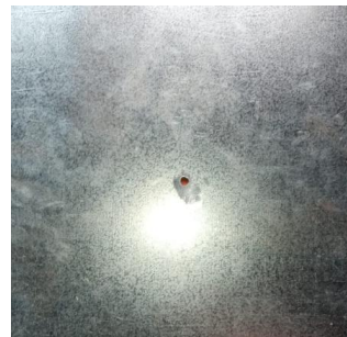
Figura 10 Lámina de aluminio con dimensiones de 25x25cm
