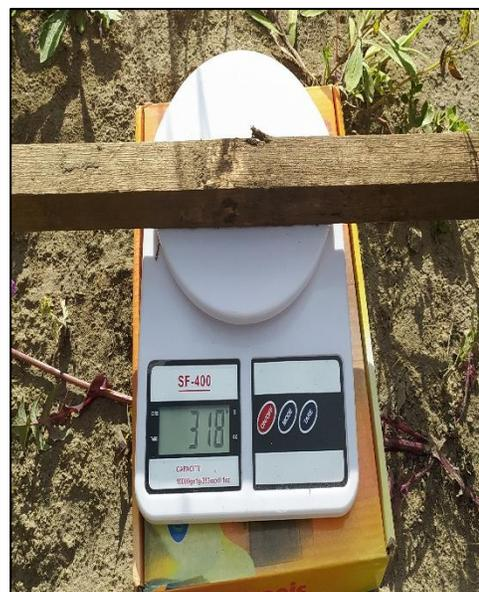
**Ilustración 16.** Registro del peso de la probeta extraída del suelo
