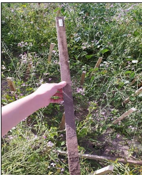
**Ilustración 15.** Probeta afectada por los agentes degradadores
