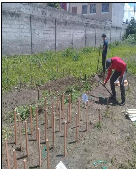
**Ilustración 12.** Enterrado de probetas en las parcelas
