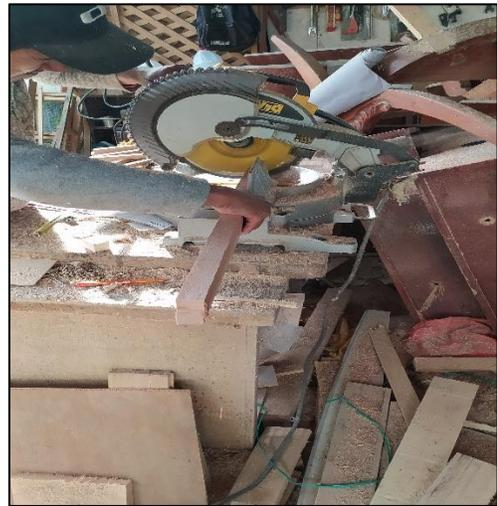
**Ilustración 4.** Despunte de las probetas
