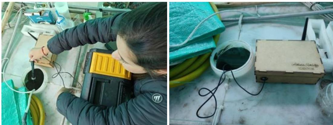
*Figura 78. Colocación de Sensor de pH en zona de medición.
