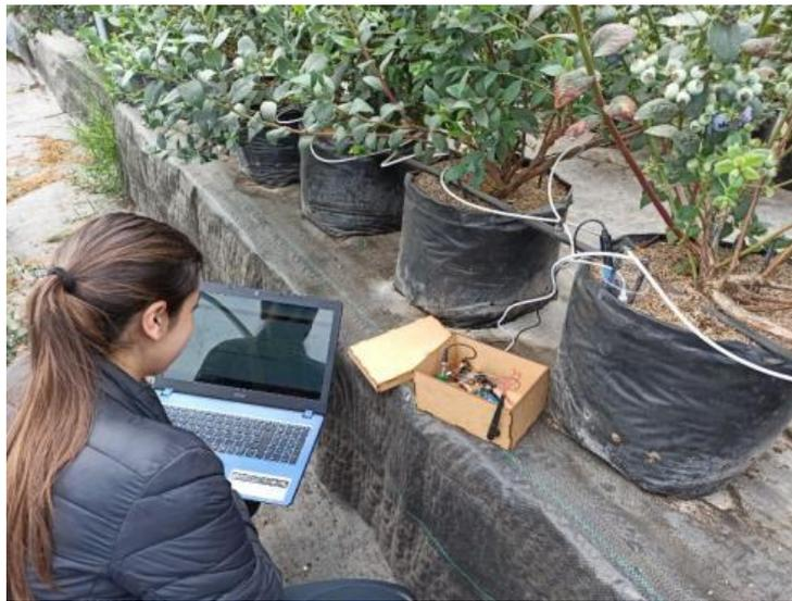
*Figura 85. Toma de datos de sensores de pH y CE en el Nodo 2.
