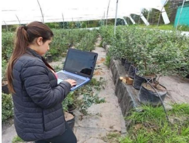
Figura 93. Toma de datos de RSSI a un metro del Nodo 2 desde el Router de Borde y a 10 metros del Nodo 1.
