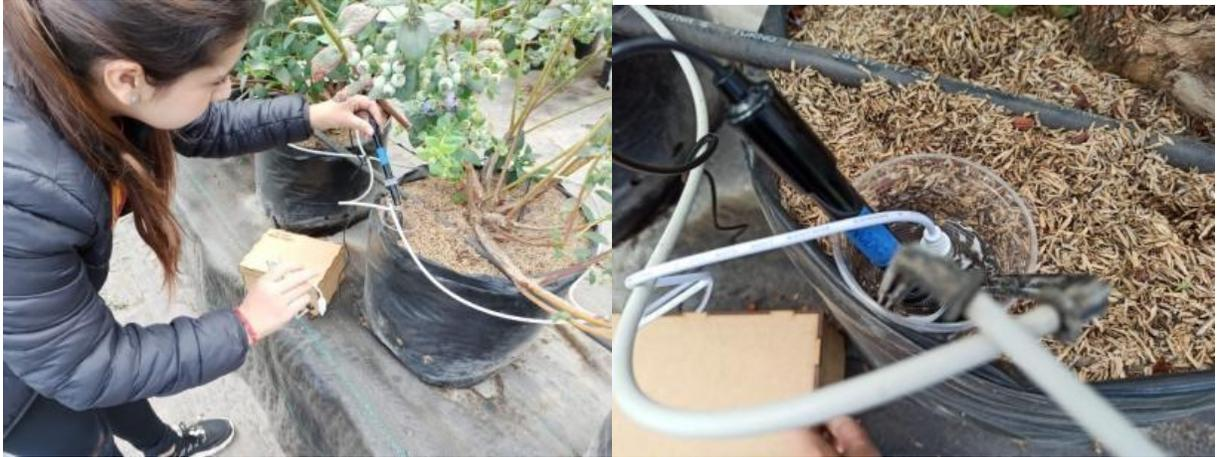
*Figura 83. Colocación de sensores del Nodo 2 en la zona de medición.
