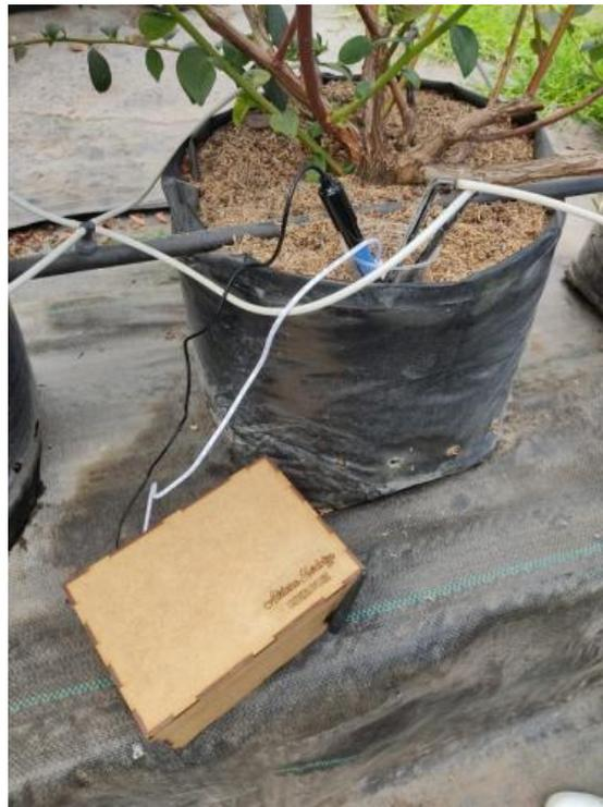
*Figura 84. Sensores colocados en la zona de toma de datos mediante el Nodo 2.
