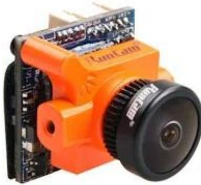
Figura. 18 Cámara FPV. Fuente: (Stonehouse, 2018).
