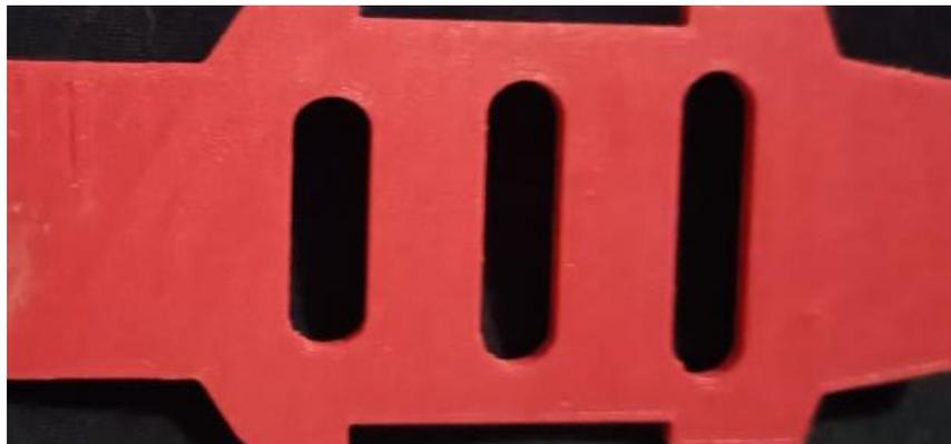
Figura. 49 Estructura media del dron. Fuente: Autor.
