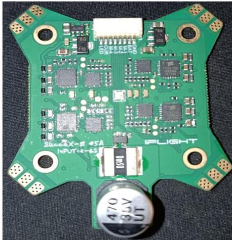
Figura. 30 Electronic speed controllers (ESC). Fuente: Autor.
