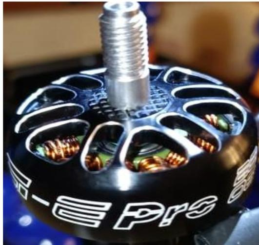
Figura. 28 Motor brushless 2306 2450 kV. Fuente: Autor.
