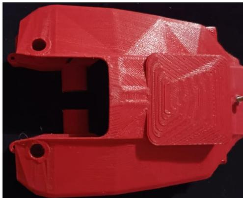
Figura. 45 Parte frontal con compartimiento para GPS. Fuente: Autor.
