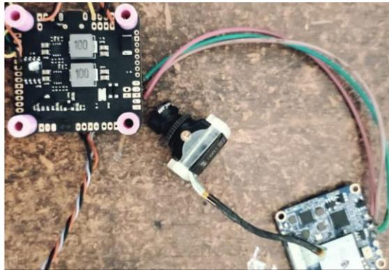
Figura. 55 Conexión entre la controladora de vuelo y la cámara FPV.
