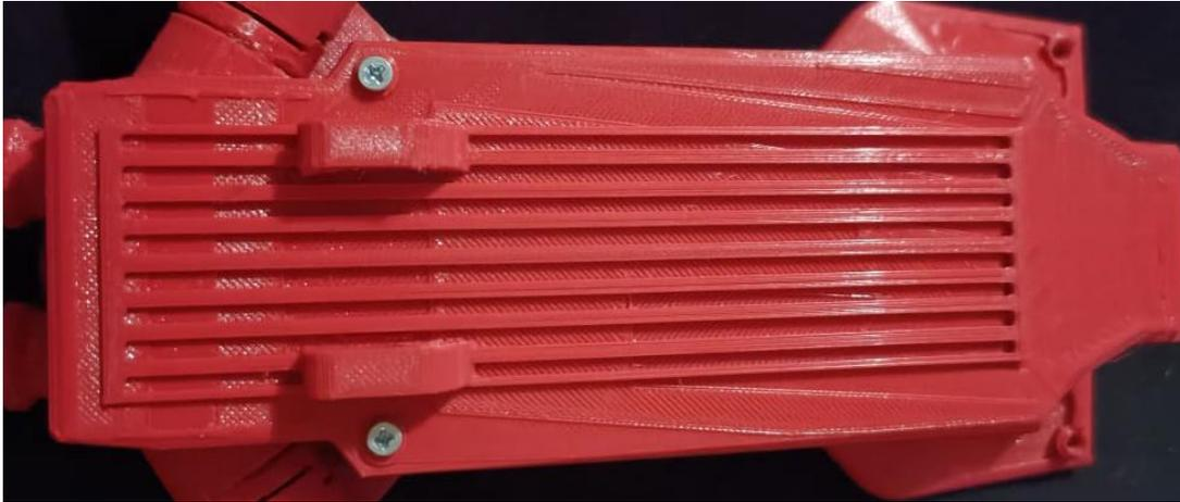
Figura. 48 Tapa inferior del dron. Fuente: Autor.
