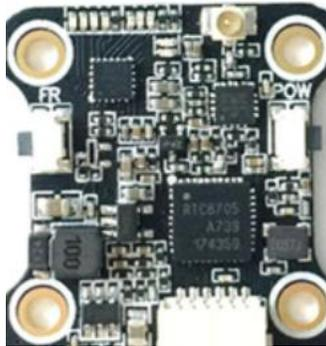
Figura. 32 Transmisor de video Eachine TX805. Fuente: Autor.
