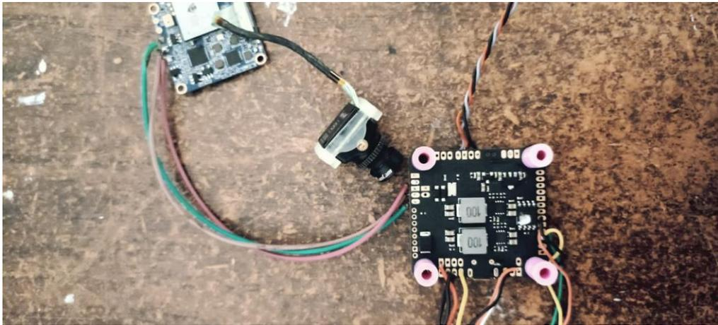
Figura. A. 8 Conexión de la cámara FPV.
