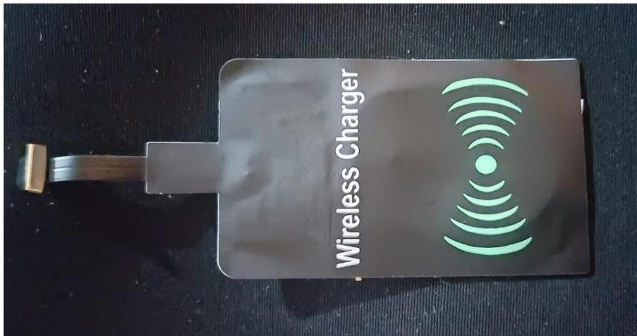
Figura. 42 Receptor de carga inalámbrica. Fuente: Autor.
