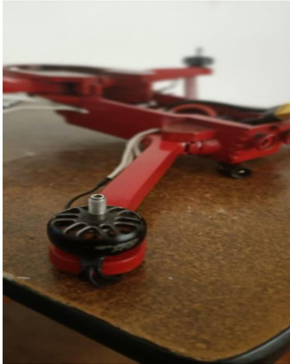
Figura. A. 5 Montaje de los motores en los brazos impresos
