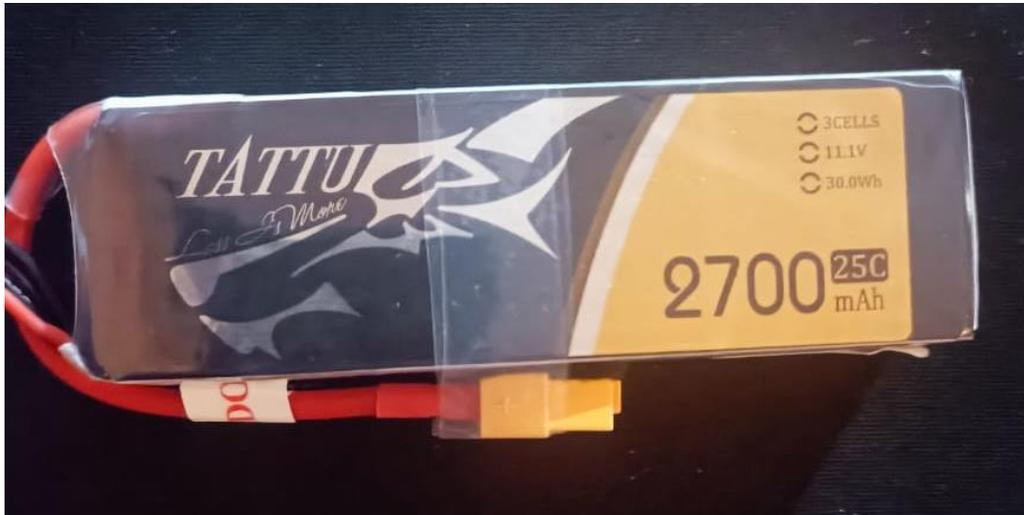
Figura. 37 Batería de Lipo 3S 2700mAh. Fuente: Autor.
