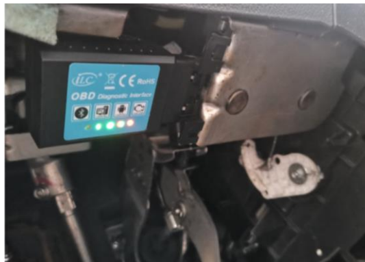
Figura 2.12 Conexión de la interfaz de diagnóstico OBD al DLC del vehículo
