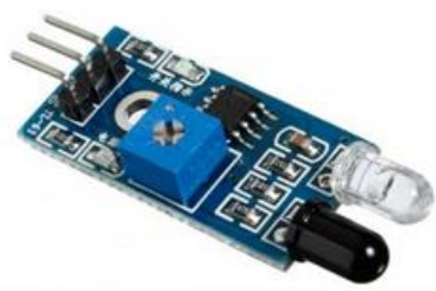
Figura 11. Circuito de sensores infrarrojos con potenciómetro de precisión para regular la distancia de detección [20].
