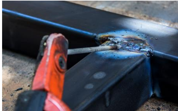
Figura 17. Soldadura eléctrica denominada blanda [25].
