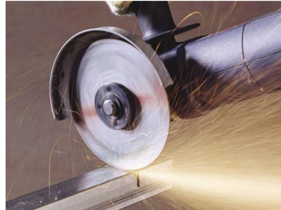
Figura 15. Corte de metales por disco de corte [23].
